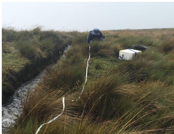
Fotografía 11: Medición de caudal canal Suito
