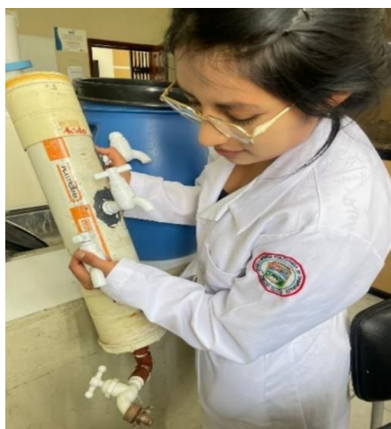
Figura 21. Montaje de las columnas de adsorción
