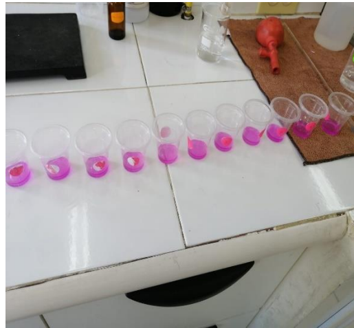
Figura 32. Titulación de muestras con lecho activado
