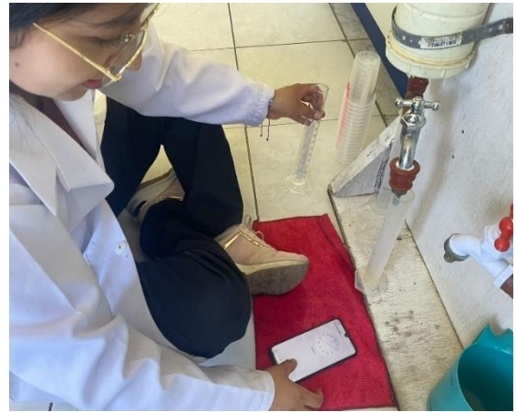
Figura 26. Medición del caudal de salida
