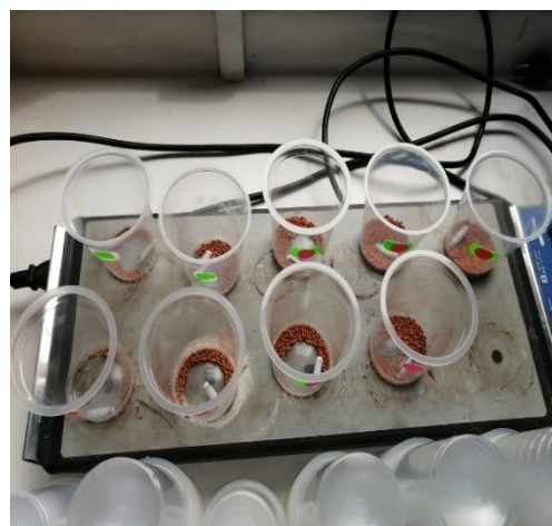
Figura 40. Montaje de la plancha de agitación
