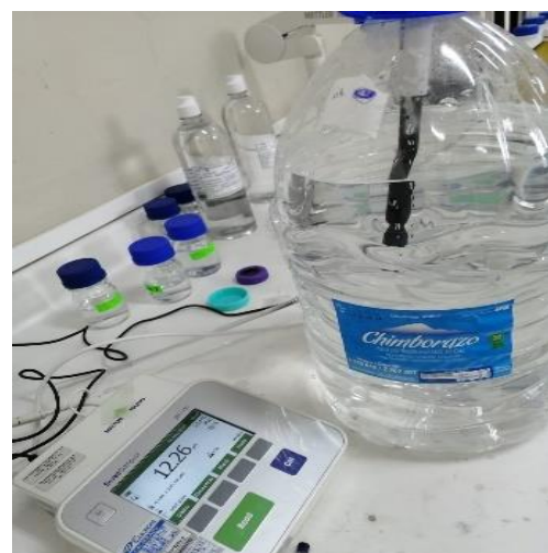
Figura 30. Medición del pH
