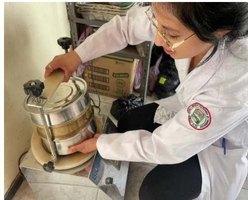
Figura 15. Tamizado del material
