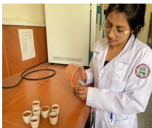
Figura 16. Colocación de los lechos en los crisoles
