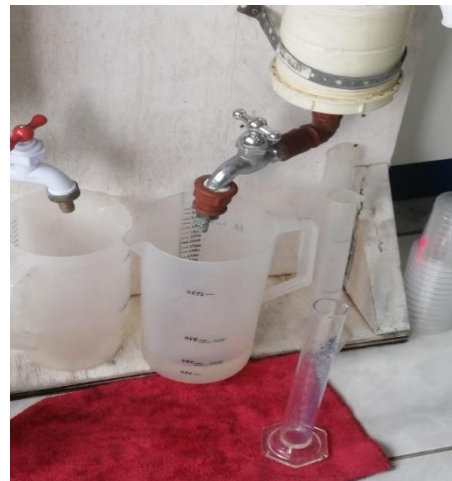
Figura 35. Toma de muestras en intervalos de tiempo
