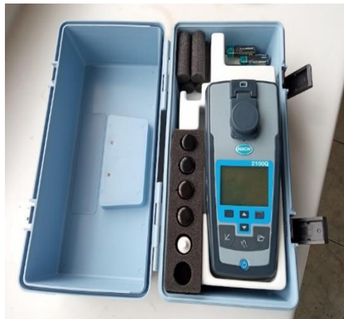
Figura 73. Turbidímetro portátil 2100Q
