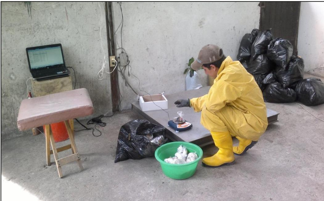
Se realiza la separación de los componentes y posteriormente se procede a registrar sus pesos.
