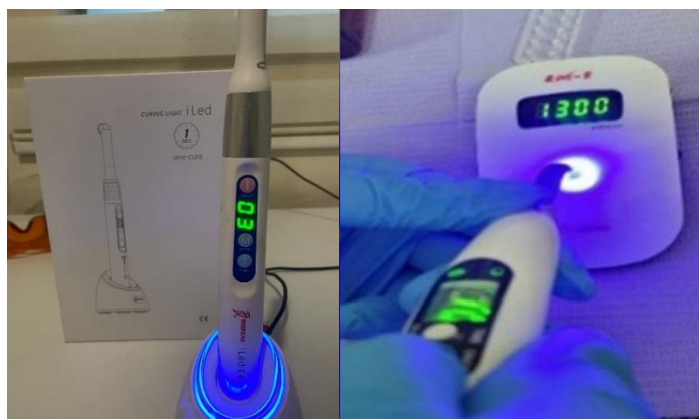
Fotografía 3. Calibración de lampara de fotocurado
