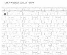
Está conformada por una losa de cimentación de piedra semi tallada la cual se encuentra a una profundidad de 50cm, el contrapiso es la continuación de la cimentación que tiene una altura de 30cm.
