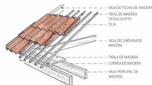
Expresada por una estructura de tijeral de par y machillo de eucalipto, su remate es de Alero sencillo y su cubierta es de teja de arcilla cocida que descansan sobre una cama de carrizo.
