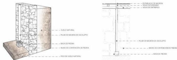
La estructura de la vivienda está conformada por pilares que son embelidos en la cimentación corrida de piedra y vigas las cuales forman varios pórticos en conjunto con los muros, las uniones entre vigas se las realiza con destajes, lo cual permite que los dos elementos conformen un solo cuerpo son asegurados con clavos, también pose unos pilares embelidos en basa de piedra que sirven para soportar del entrepiso y sus gradas son de piedra.
