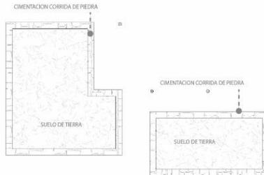
Está conformada por pilastras de 40x40cm, con una profundidad de 60cm de los cuales 40cm van bajo tierra y 20 cm sobresalen de la misma donde descansa el pilar, también tiene un pequeño muro de 20cm de piedra que recorre el perímetro en forma de cadena que sirva para que se asienten los muros.
