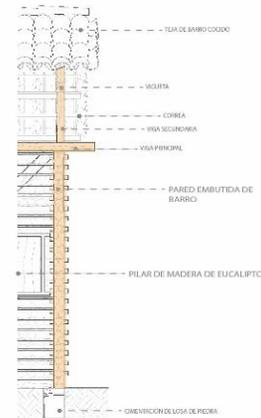
La estructura de la vivienda está conformada por pilares que son embudidos en pilas y vigas las cuales forman varios pórticos en conjunto con los muros, las uniones entre vigas se las realiza con destajes, lo cual permite que los dos elementos conformen un solo cuerpo los cuales son asegurados con clavos.
