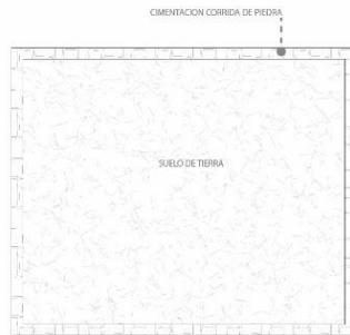
Está conformada por pilastras de 40x40cm, con una profundidad de 60cm de los cuales 40cm van bajo tierra y 20 cm sobresalen de la misma donde descansa el pilar, también tiene un pequeño muro de 20cm de piedra que recorre el perímetro en forma de cadena que sirva para que se asienten los muros.
