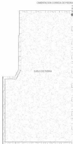
Está conformada por una cimentación corrida de piedra semi tallada la cual se encuentra a una profundidad de 50cm, la cual se eleva a una altura promedio de 15cm en su frente y es parte posterior de 80cm debido a su desnivel conformando el embasamento.
