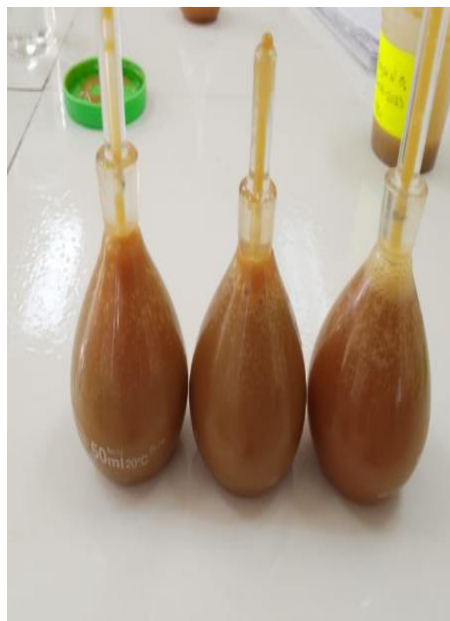
Figura 8 Determinación de la densidad de los majares
