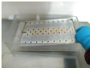
Ilustración 2.15 Cámara húmeda horizontal
