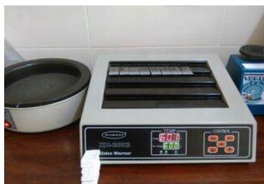
Ilustración 2.11 Secador de Laminillas Histológicas (Plancha Caliente)
