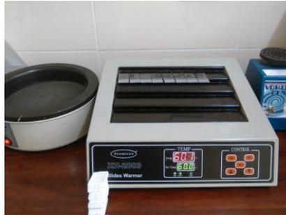
Ilustración 2.17 Secador de Laminillas Histológicas (Plancha Caliente) Fuente: Centro Medico Diagnosticas laboratorio de anatomía patológica
