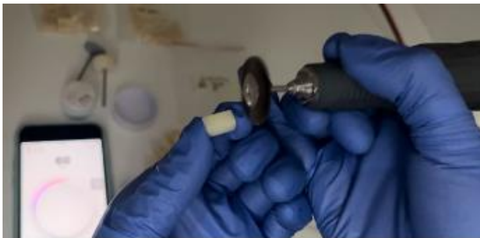
11. Fotografía. Proceso de pulido con disco de pelos de cabra y con pasta Dura Polish.
