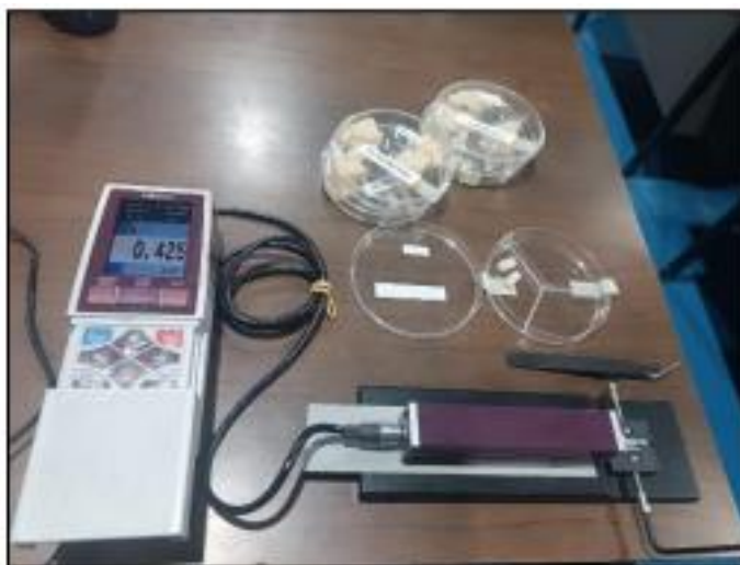
16. Fotografía. Medición de los bloques de muestra con el rugosímetro digital
