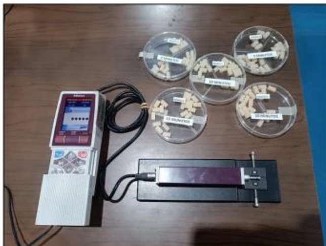
15. Fotografía. Metodología de medición de los bloques de muestra con el rugosímetro digital
