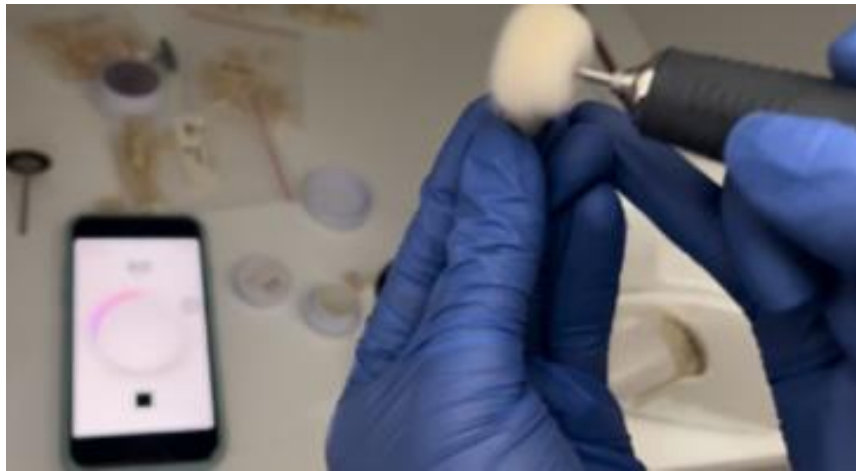
12. Fotografía. Proceso de pulido con disco de fieltro y con pasta Dura Polish Dia.
