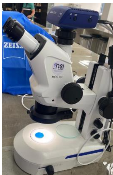
Fotografía 13. Colocación de la muestra en la platina.
