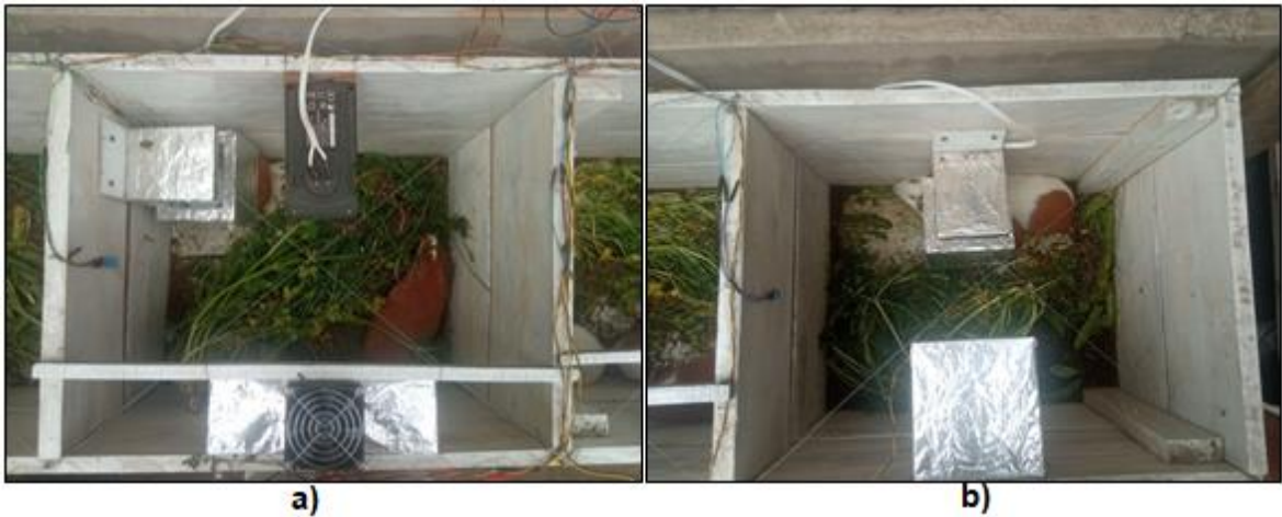
Figura 36: a) Jaula con control de temperatura y humedad, b) Jaula 4 con control de humedad y con temperatura ambiente.
