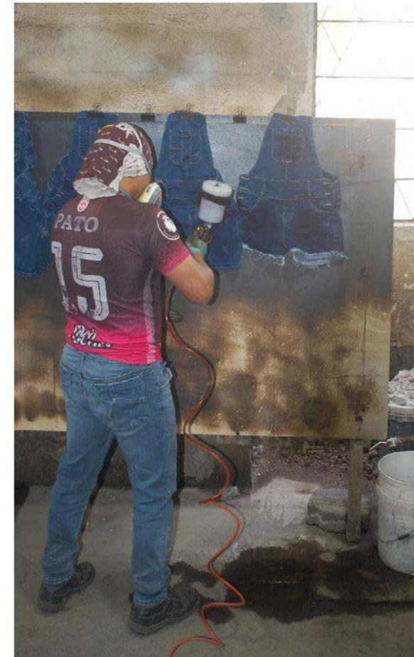
**Ilustración 10:** Aplicación de químico para esponjado textil. Planta de tinturado Denim, Industria Bays Bils - Pelleo.
