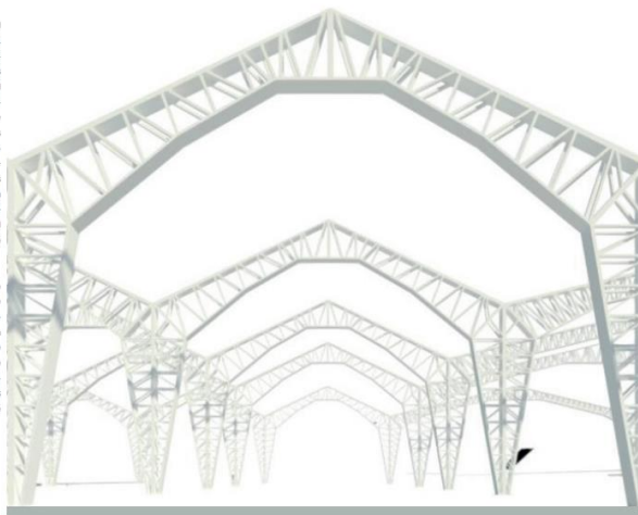
Ilustración 131. Modelado de pórticos Naves Ecuacerámica Fuente: Elaboración propia
