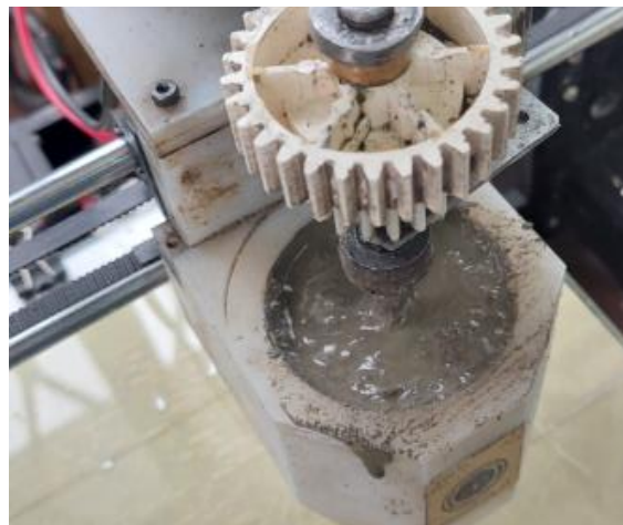
Figura 8.- Extrusor con mortero.
