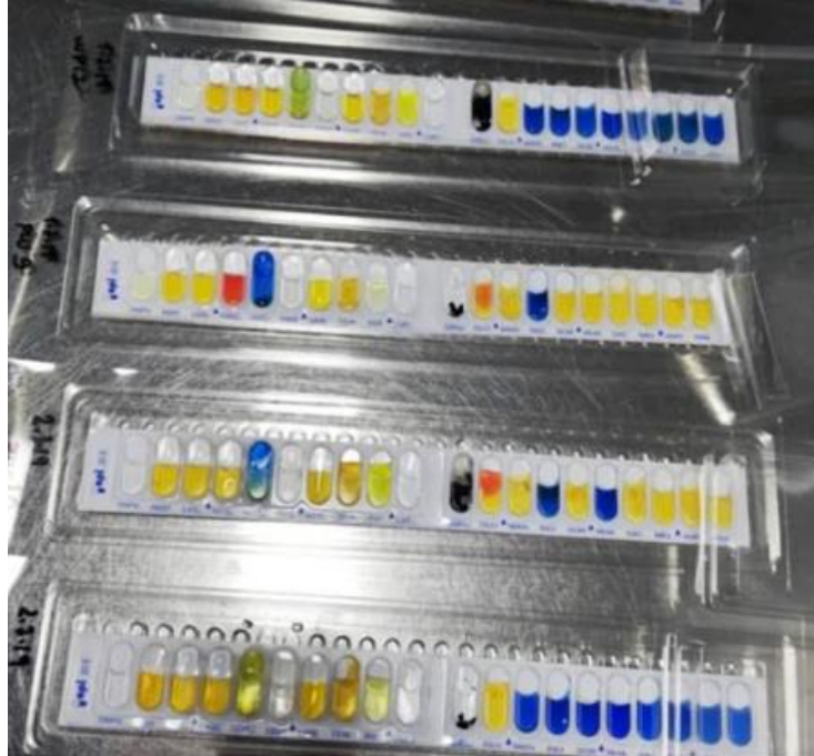
Fotografía 10. Identificación de microorganismos mediante el sistema miniaturizado API.
