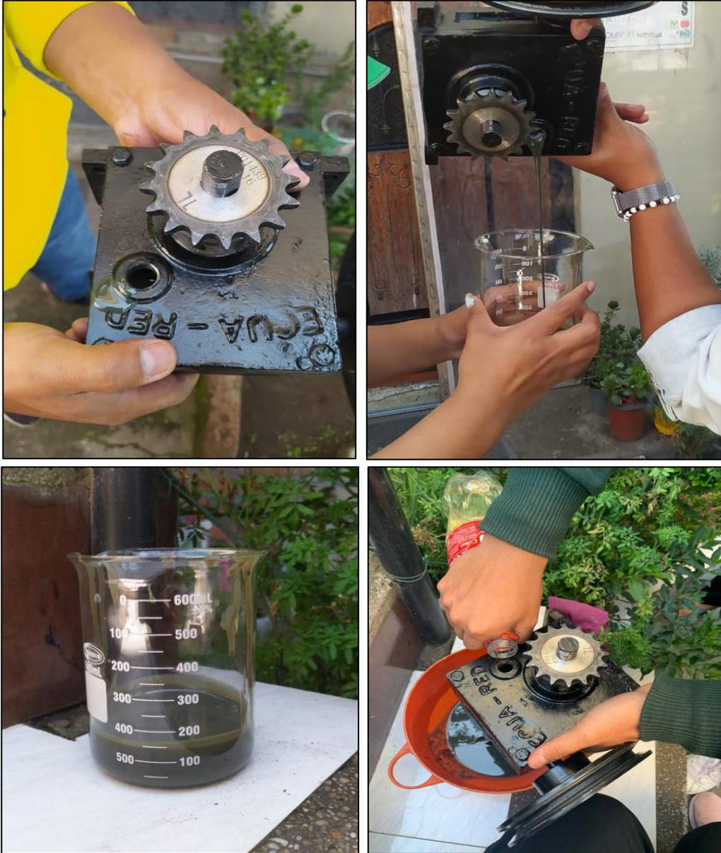
*Nota.* Retiro del lubricante original de la caja reductora, para conocer el contenido exacto en el interior de este y su correspondiente limpieza con el líquido desengrasante (Thinner) para la eliminación de todos los residuos anteriores.
