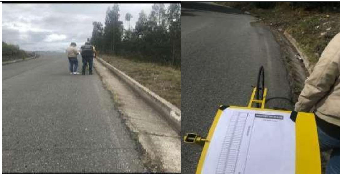
Foto 1 Ensayo mediante el rugosímetro Merlín en la vía Riobamba – Pulinguí.
