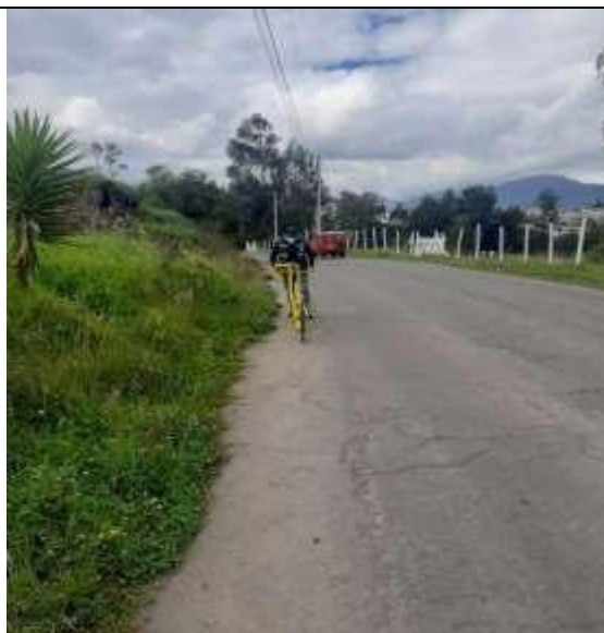
Foto 3 Ensayo mediante el rugosímetro Merlín en la vía Chambo – Cubijés.
