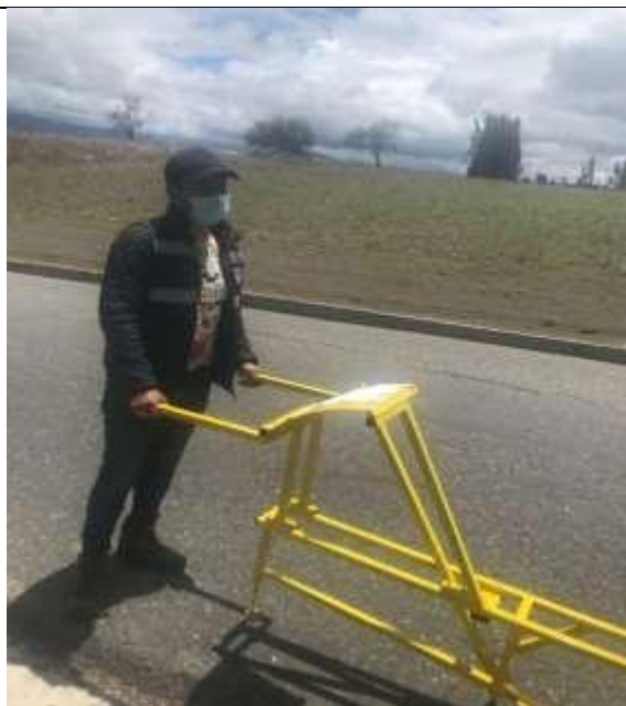
Foto 4 Ensayo mediante el rugosímetro Merlín en la vía Chambo – Cebadas.
