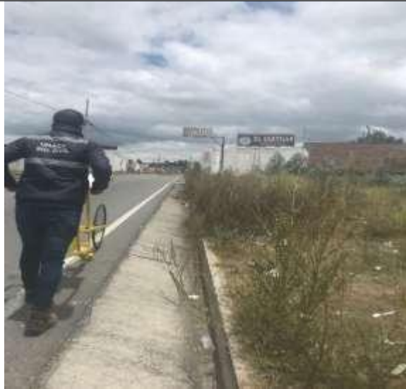
Foto 1 Ensayo mediante el rugosímetro Merlín en la vía Riobamba – Pulinguí.
