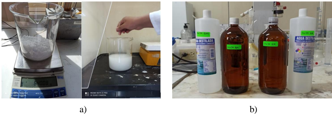
Figura 10. a) Disolución del NaOH en agua destilada y b) Soluciones de NaOH a 8 y 12 M
