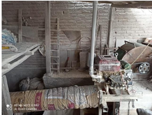
Figura 8. Molienda y tamizado de la PP
