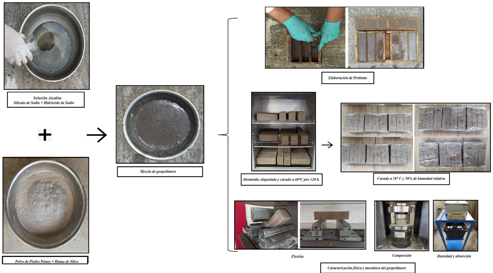
Figura 14. Esquematización del proceso de fabricación del geopolímero
