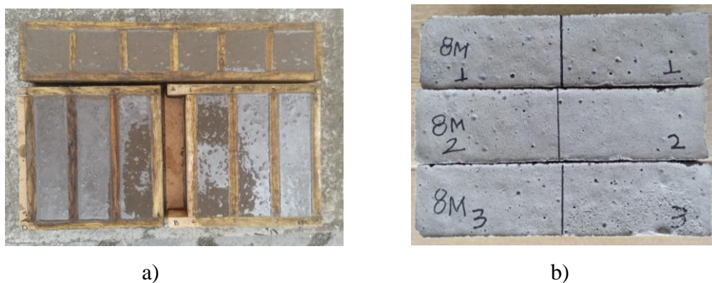
Figura 12. a) Reposo de 24 h de las probetas, b) Desmolde y etiquetado
