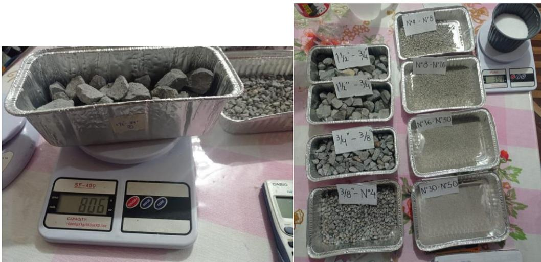
**Anexo 88.** Preparación de las muestras para el ensayo de resistencia a los sulfatos.
