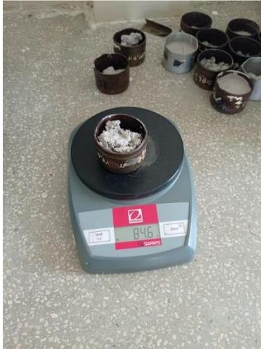
**Anexo 75.** Pesaje de las muestras secas del ensayo de CBR.
