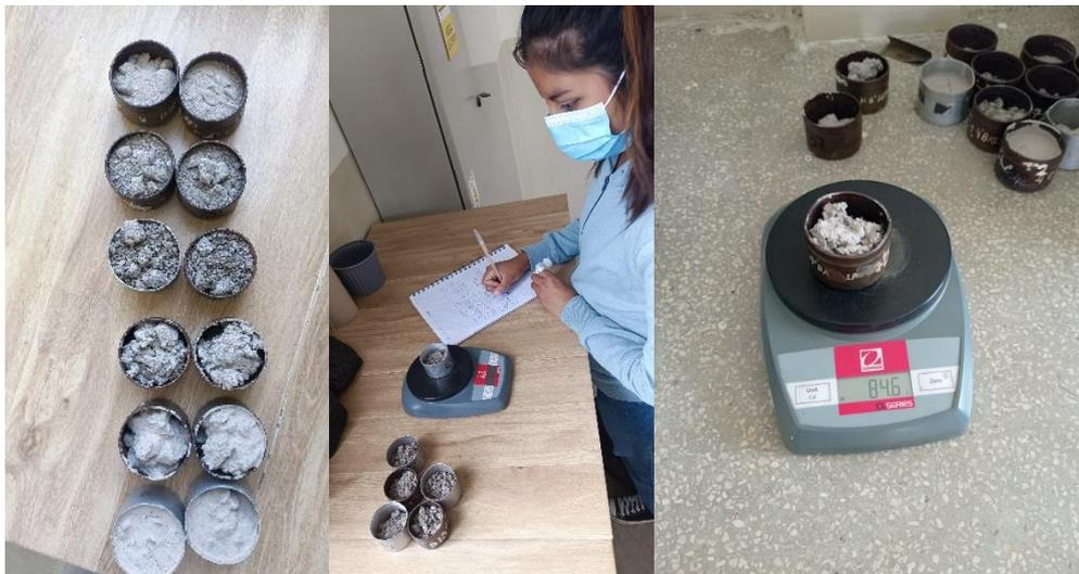
**Anexo 50.** Pesaje de las muestras obtenidas durante el ensayo de humedad óptima.
