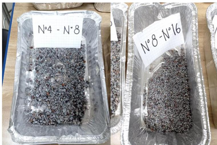
**Anexo 95.** Resistencia a los sulfatos – Muestras secas del árido fino.
