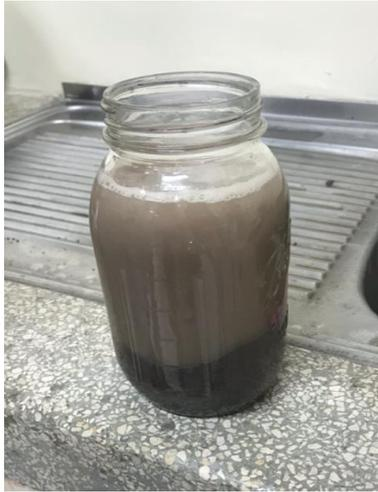
**Anexo 102.** Pesaje del picnómetro con muestra y agua hasta la marca de calibración.
