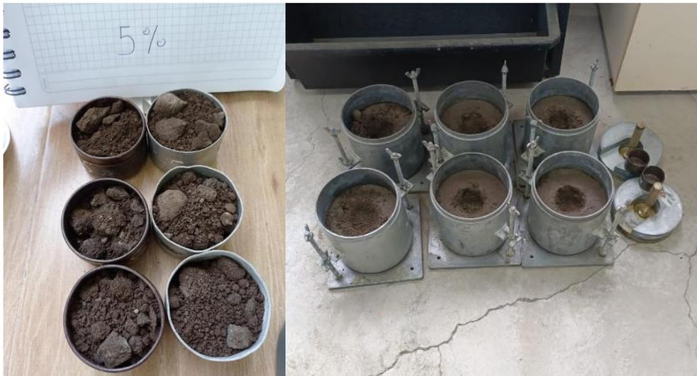
**Anexo 73.** Extracción de muestras de las probetas ensayadas de CBR.
