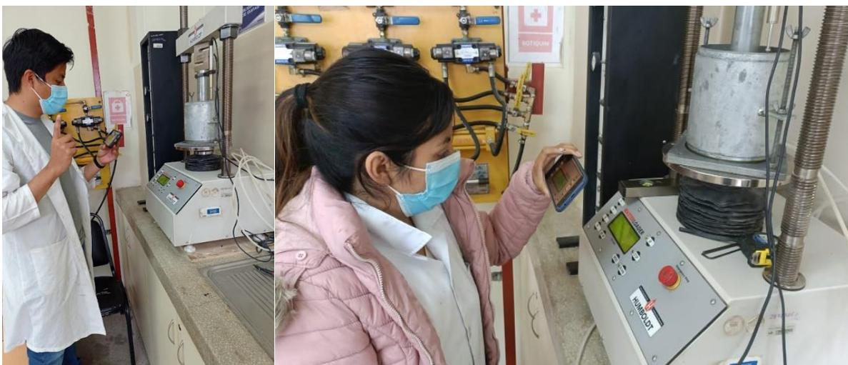
**Anexo 71.** Lectura y toma de datos de la carga y deformación de cada probeta ensayada.
