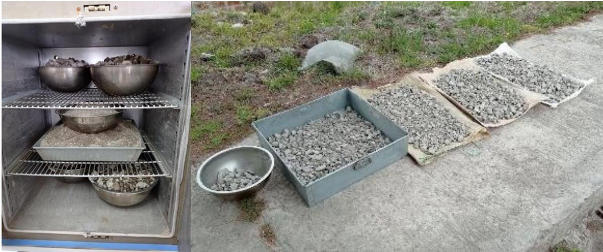
**Anexo 34.** Secado de material para la realización del ensayo de granulometría.
