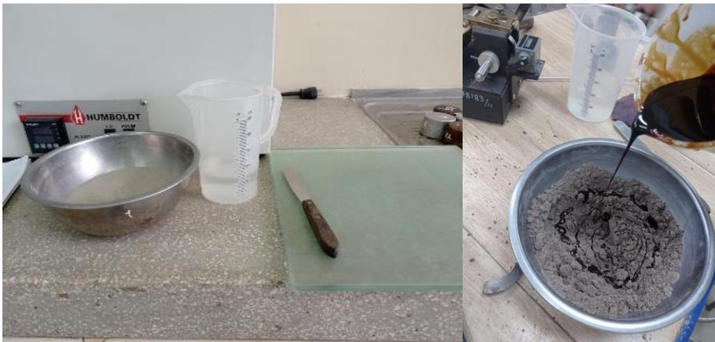
**Anexo 77.** Preparación de los equipos y muestra para la realización de límites de Atterberg con adición de miel de caña.
