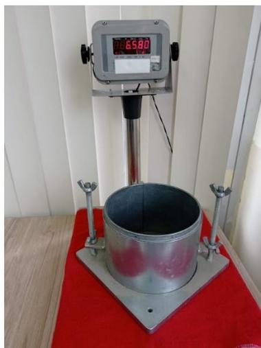
**Anexo 47.** Pesaje del molde de Proctor a utilizar.
