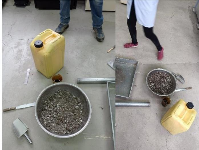
**Anexo 51.** Preparación del ensayo de densidad óptima en diferentes porcentajes de adición de melaza de caña.
