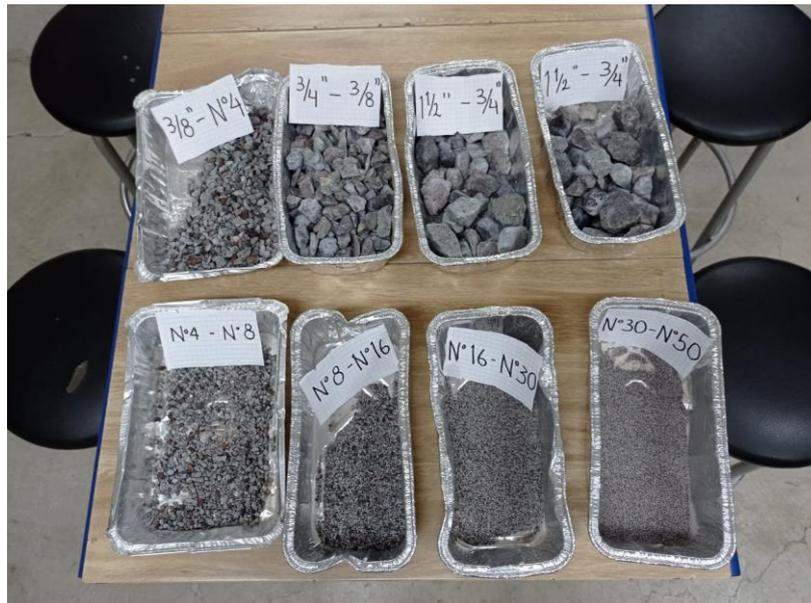
**Anexo 97.** Resistencia a los sulfatos - Muestras ensayadas.
