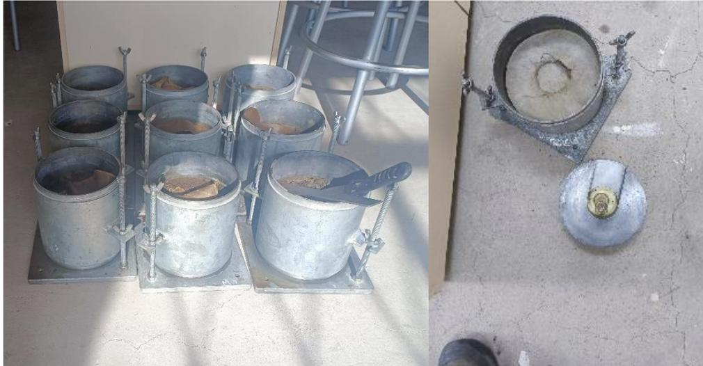
**Anexo 72.** Probetas de CBR ensayadas.
