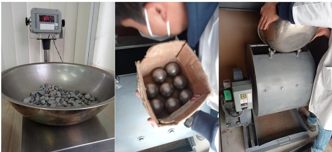
**Anexo 44.** Preparación de equipo y material para la realización del ensayo de abrasión.
