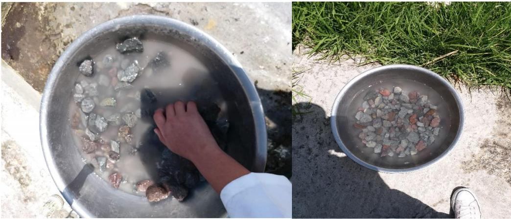
**Anexo 109.** Lavado del árido grueso e inmersión para el ensayo.
