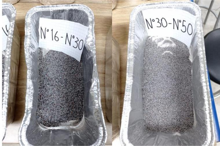
**Anexo 96.** Resistencia a los sulfatos – Muestras secas del árido fino.
