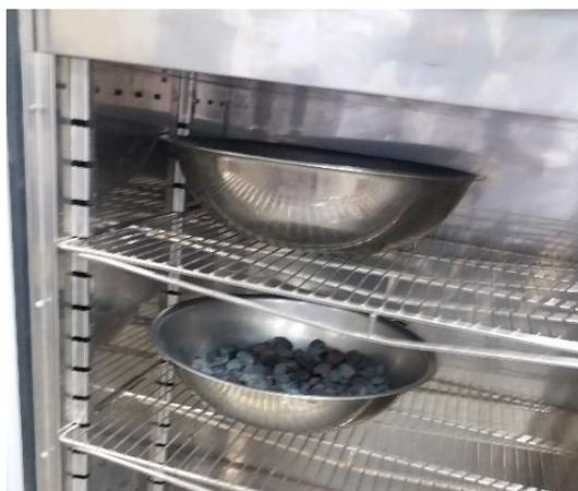
**Anexo 113.** Secado en horno de la muestra ensayada.
