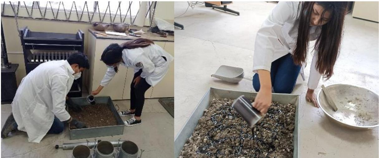
**Anexo 55.** Preparación del material a compactar para la realización del ensayo CBR.
