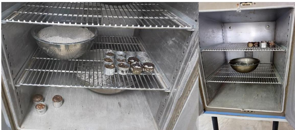
**Anexo 74.** Secado en horno de las taras con las muestras de los ensayos de CBR realizados.
