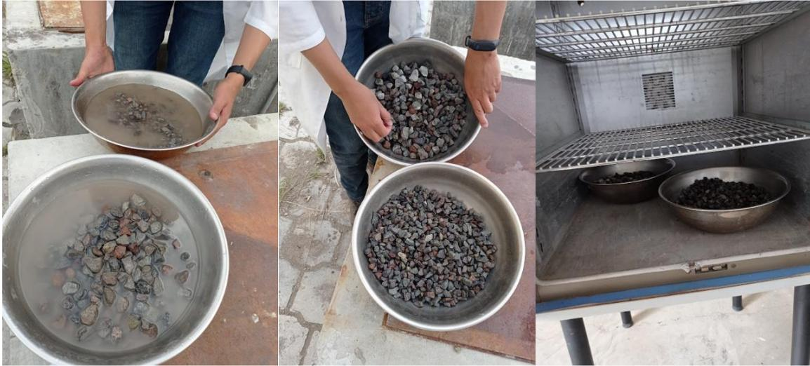
**Anexo 42.** Preparación de la muestra para la realización del ensayo de abrasión.
