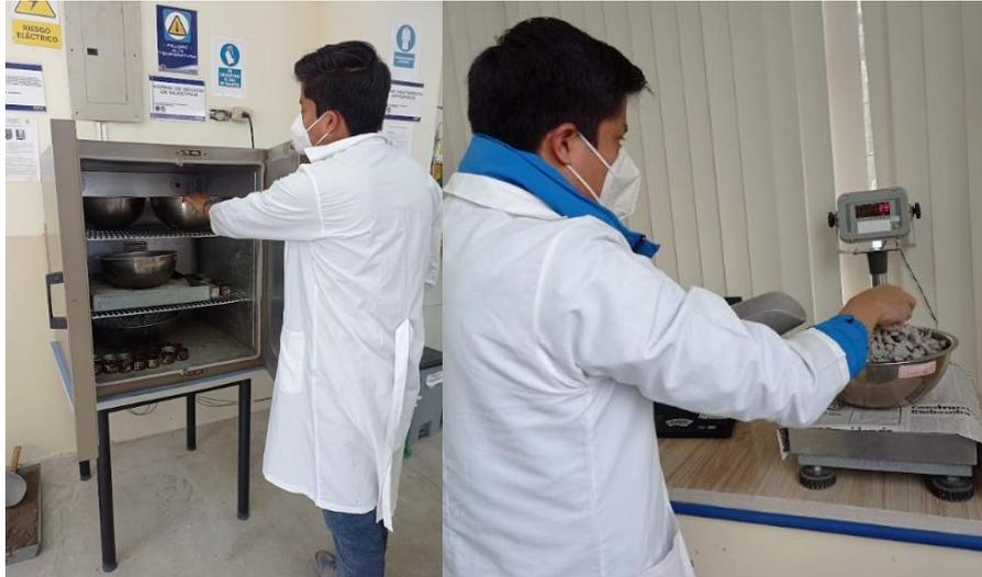
**Anexo 48.** Preparación de la muestra a usar durante el ensayo de Proctor.
