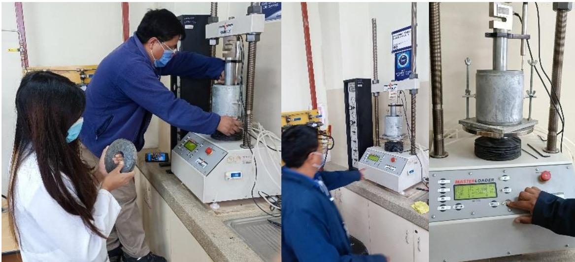
**Anexo 70.** Preparación y configuración de la muestra con la prensa Marshall.
