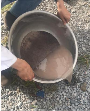
**Anexo 99.** Decantación del exceso de agua en la muestra tras haber estado sumergida 24h.
