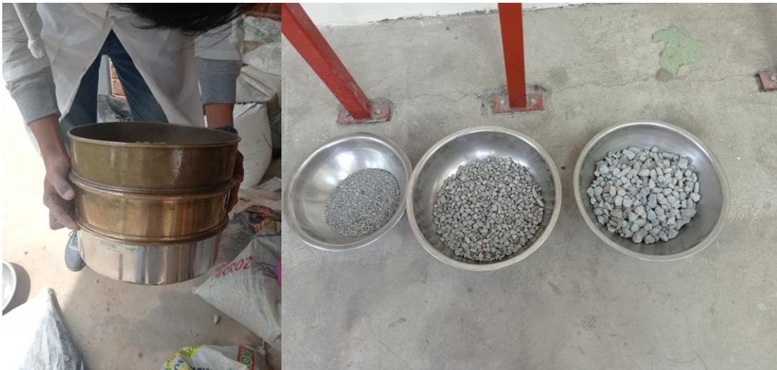
**Anexo 83.** Tamizaje y preparación de la muestra para el ensayo de determinación de deletéreos.
