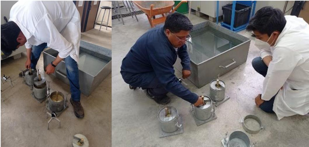
**Anexo 61.** Colocación de las pesas en las probetas compactadas.
