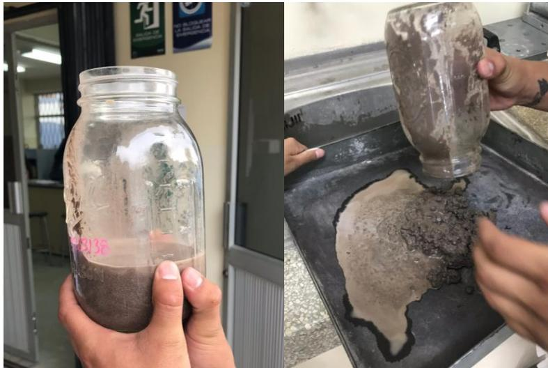
**Anexo 104.** Eliminación del agua y extracción de la muestra del picnómetro.
