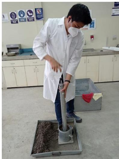
**Anexo 59.** Compactación de las probetas a ensayar.
