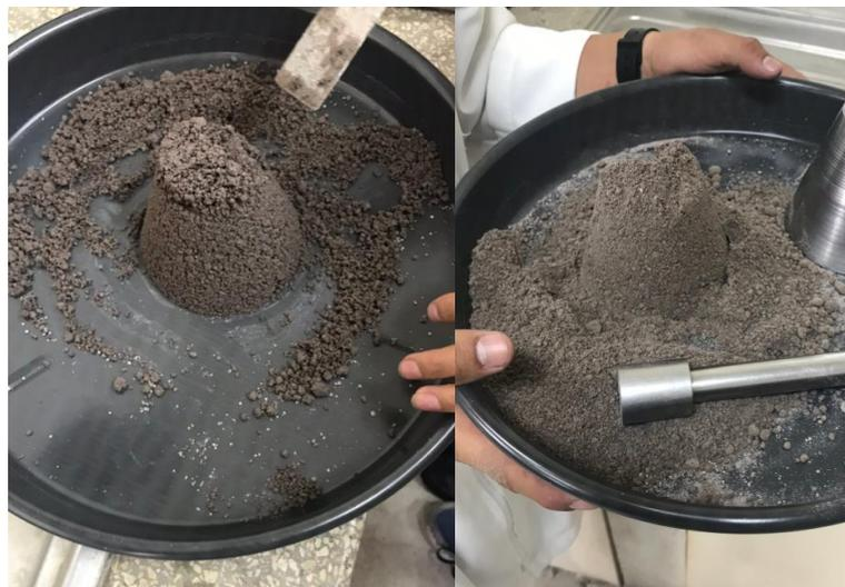
**Anexo 101.** Prueba con el cono de absorción para la muestra en condición SSS.
