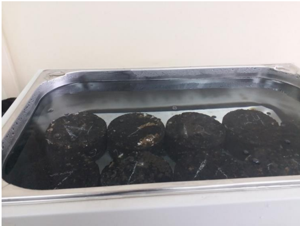
Figura 33 Preparación de briquetas Fuente: (Noboa, 2022)
