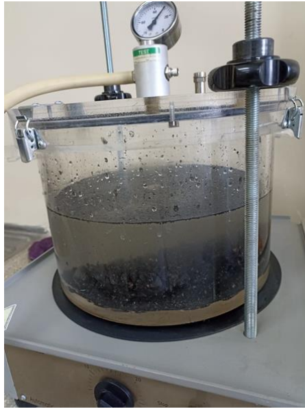
Figura 36 Ensayo de gravedad máxima medida Fuente: (Noboa, 2022)
