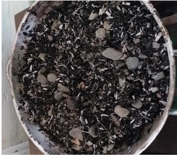
Figura 28 Mezcla con mascarillas vía seca Fuente: (Noboa, 2022)
