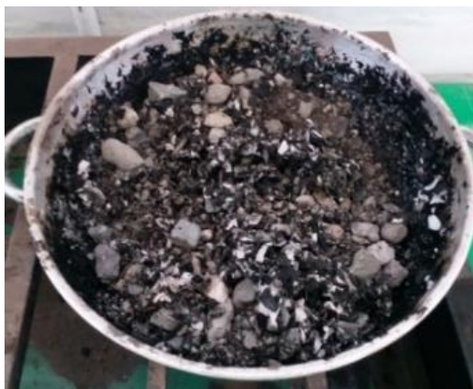
Figura 6 Incorporación de mascarilla vía húmeda Fuente: (Noboa, 2022)
