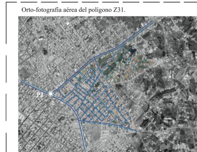
Figura 86: Red de agua potable y alcantarillado del polígono Z31.
