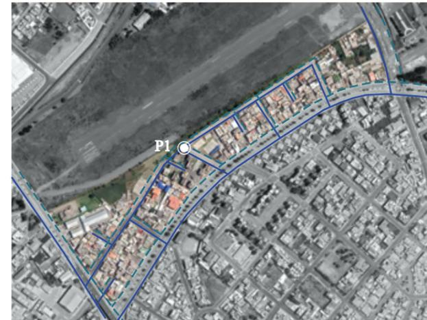
Figura 9: Red de agua potable y alcantarillado del polígono Z3.
