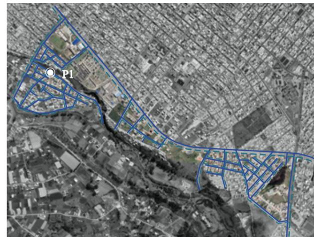
Figura 107: Red de agua potable y alcantarillado del polígono Z38 (TII-III).
