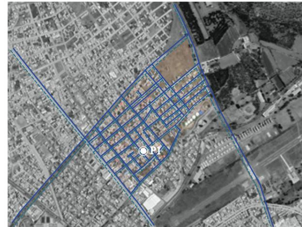
Figura 58: Red de agua potable y alcantarillado del polígono Z23.
