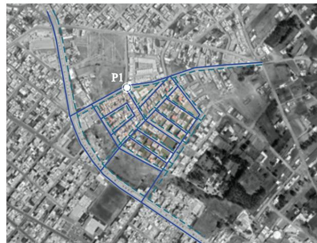
Figura 93: Red de agua potable y alcantarillado del polígono Z33.
