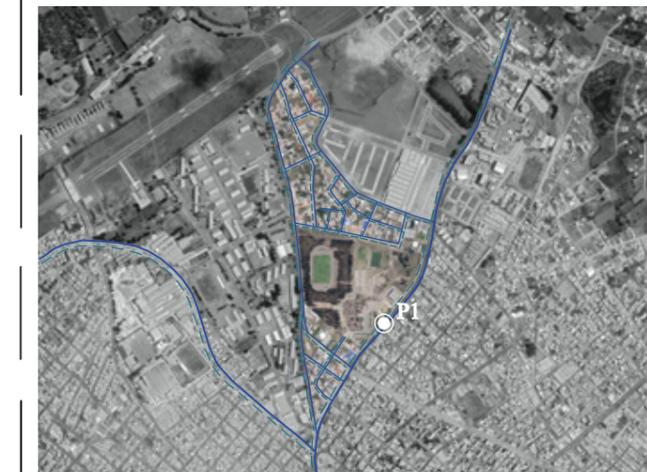
Figura 72: Red de agua potable y alcantarillado del polígono Z26.
