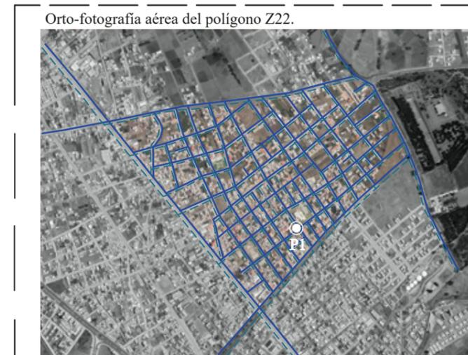
Figura 51: Red de agua potable y alcantarillado del polígono Z22.
