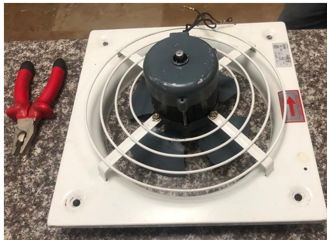
Figura 6. Base del motor
