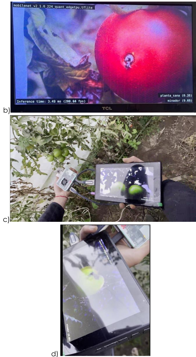
Figura 28. a) Prototipo en prueba final de funcionamiento con una sola predicción. b) Prototipo en prueba final de funcionamiento con predicción de varias clases. c) Prototipo en prueba final en invernadero con predicción de varias clases d) Prototipo en prueba final en invernadero con una sola predicción.
