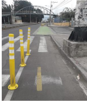
Ilustración 36. Ancho de ciclovía, líneas separadoras, líneas continuas, separadores viales, señalética horizontal, vertical y cruce de intersección de la ciclovía Transversal
