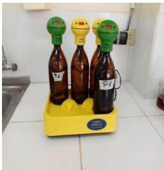
**Imagen 8.** Equipo medidor de DBO<sub>5</sub>
