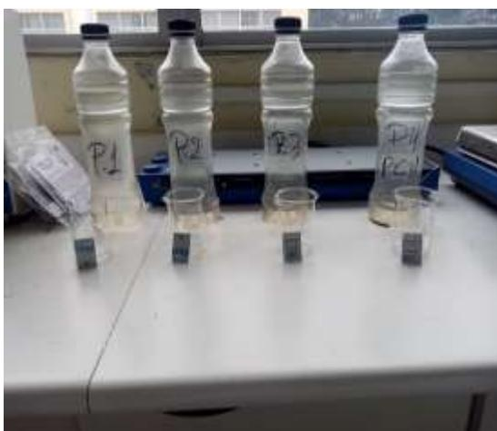
**Imagen 11.** Medición de nitratos y fosfatos
