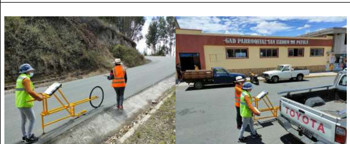
Foto 2 Ensayo de rugosidad en la vía San Andrés - San Isidro de Patulú
