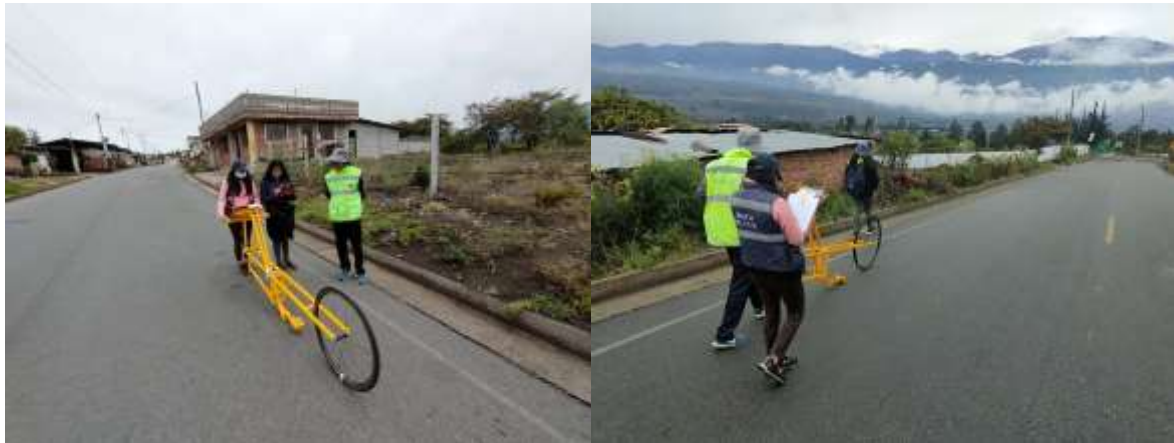
Foto 4 Ensayo de rugosidad en la vía Guano-Valparaíso
