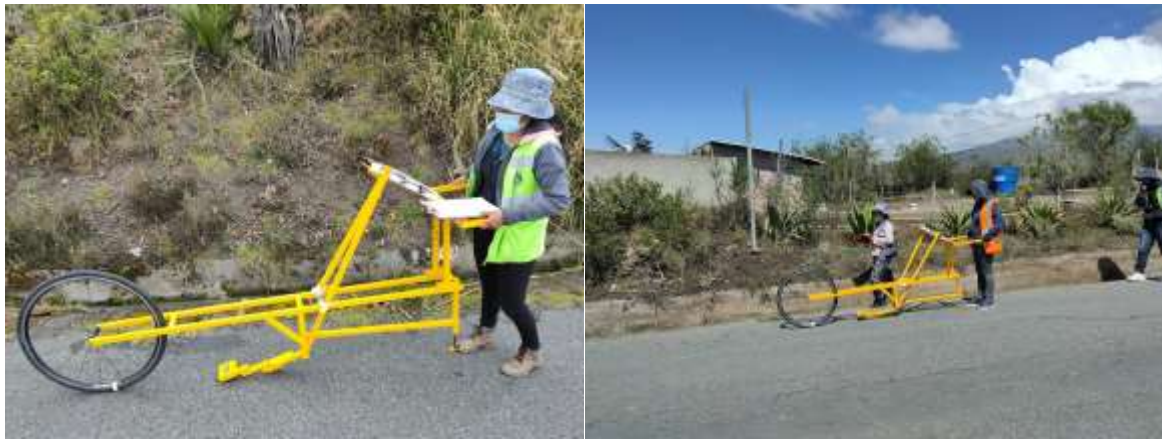
Foto 3 Ensayo de rugosidad en la vía Guano-Ilapo
