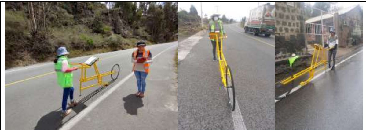
Foto 1 Ensayo de rugosidad en la vía Guano-San Andrés.
