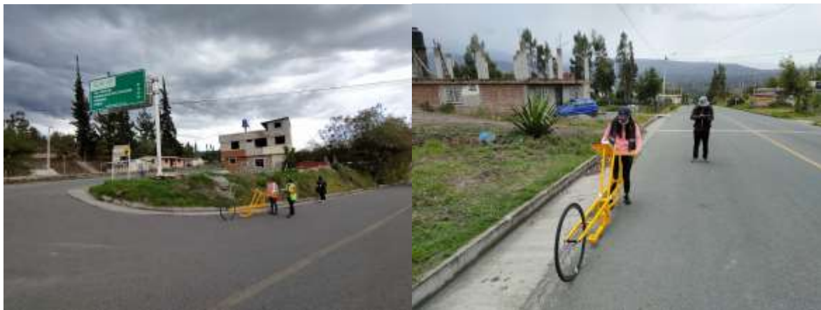
Foto 5 Ensayo de rugosidad en la vía Guano-San Gerardo de Pacaicaguán
