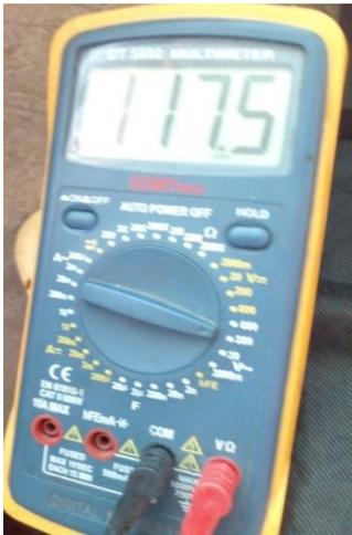
Figura 20. Valor medido a la línea 1 de voltaje en AC
