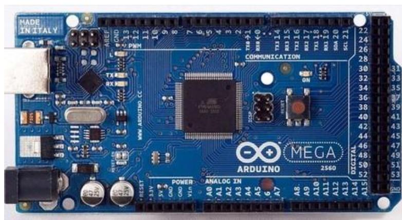
Figura 1. Arduino mega 2560
