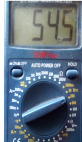
Figura 24. Valor medido del banco de baterías.
