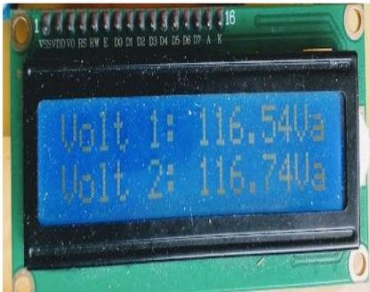
Figura 21. Valores del voltaje de línea 1 y 2.
