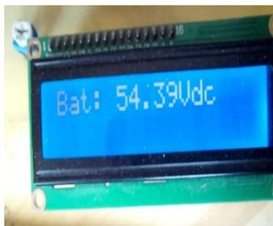
Figura 23. Lectura del voltaje del banco de baterías
