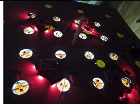
Figura 58 Encendido de los 16 focos led sin acrílicos y con un dispositivo independiente para la modulación de cada foco Fuente: Autor
