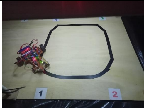
Figura 57 Pruebas de movimiento y velocidad del robot seguidor de línea Fuente: Autor
