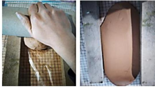
Con la ayuda de un rodillo se da forma de una plancha, con un esteque o herramienta que pueda cortar, los bordes sobrantes se cortan y se obtiene la plancha, si en caso va a realizar una canasta cuadrada se realiza el mismo proceso con los demás bordes.
