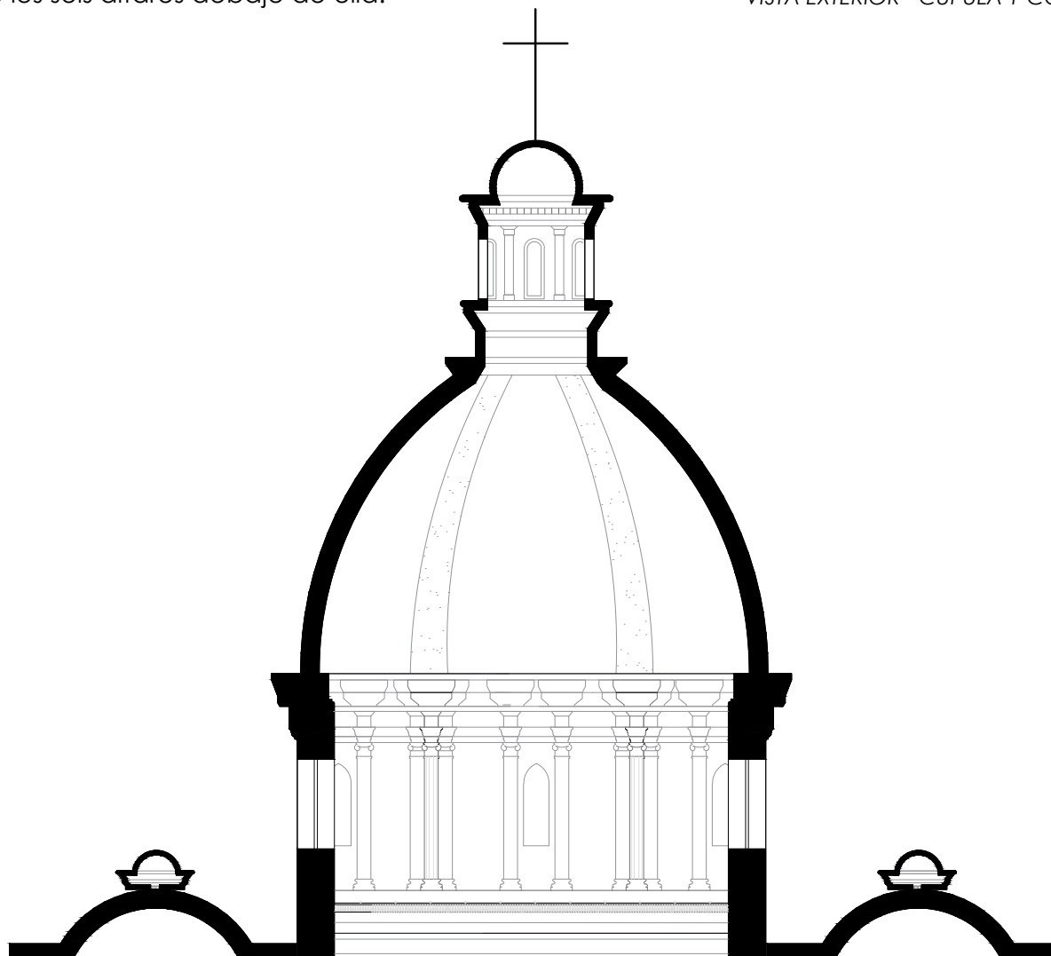
CORTE TRANSVERSAL - CÚPULA
