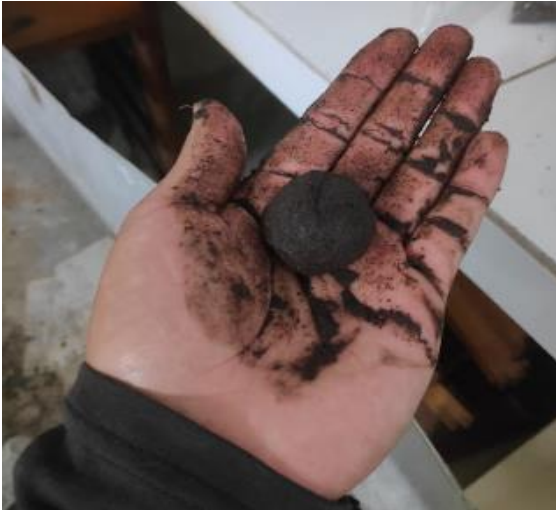
Imagen 21. Prueba de textura de la muestra de suelo
