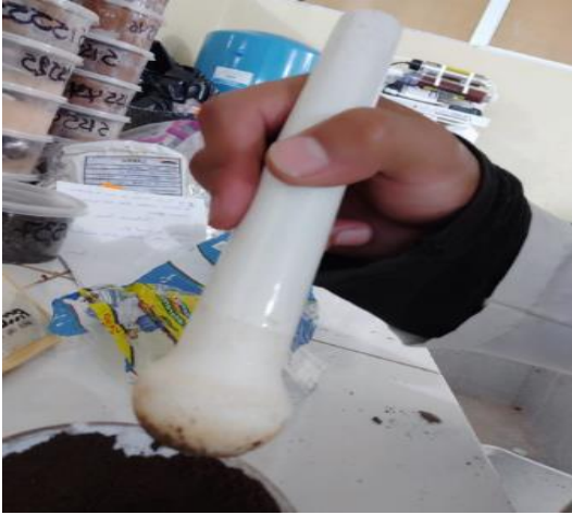
Imagen 19. Homogenización de la muestra en mortero
