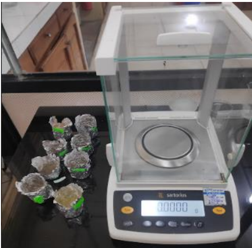
Imagen 15. Balanza analítica para pesaje
