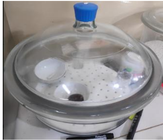
Imagen 14. Reposo de la muestra en el desecador
