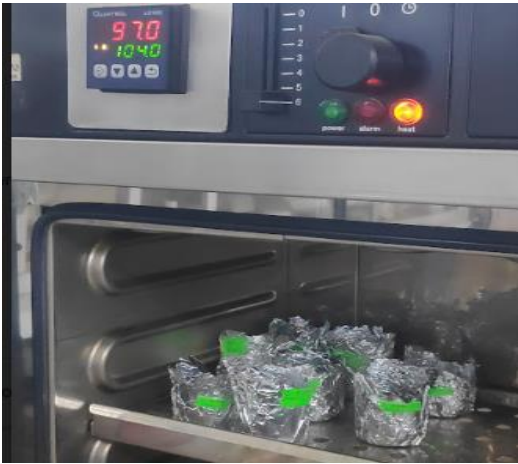
Imagen 13. Secado de la muestra para la determinación de sustancia seca.
