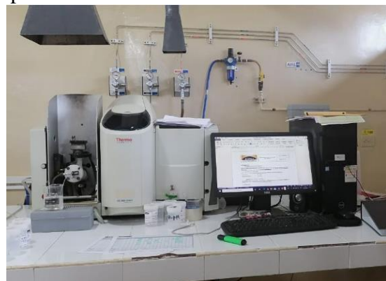
Imagen 12. Espectrofotometro Thermo SOLAAR iCE 3000 series.
