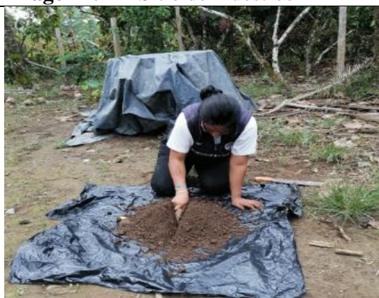
Imagen 3. Cuarteo para la muestra a analizar
