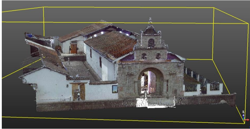
Figura 29 Nube de puntos depurada bajo un proceso de segmentación. Fuente: Elaboración propia.
