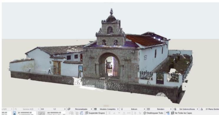
Figura 33 Nube de puntos limpia, en formato e57 con aristas e intersecciones marcadas.
