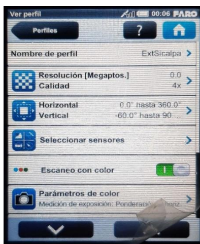
Figura 20 Apertura angular del levantamiento. Fuente: Elaboración propia.
