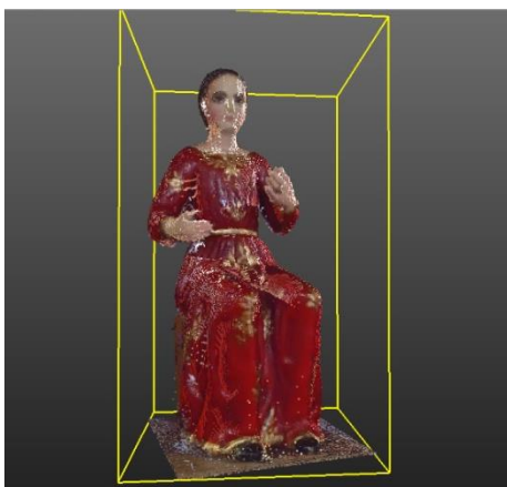
Figura 31 Nube de puntos a detalle después de segmentación. Fuente: Elaboración propia.
