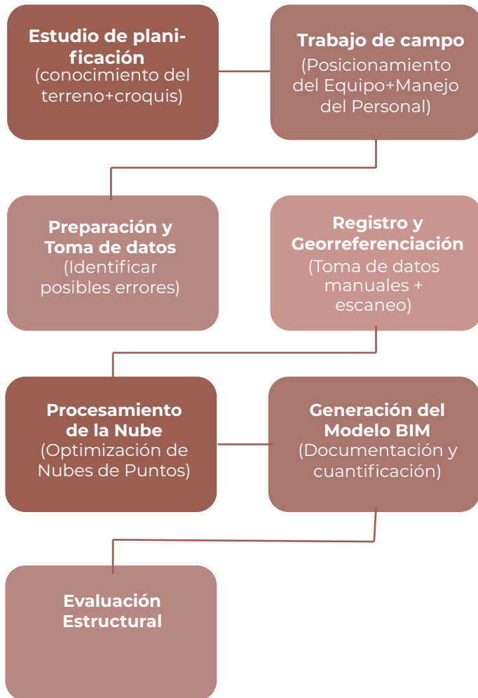
(Título: flujo de trabajo con escáner láser 3D para documentación y evaluación)
