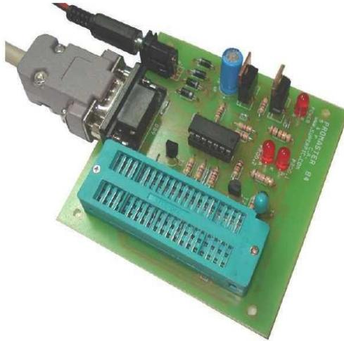
Figura 2.26: Programador de Microcontroladores
