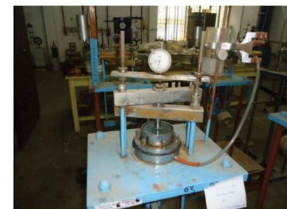
Figura 26 Aparato de prueba de edómetro para la determinación de la presión de hinchamiento según ASTM D4546-14 (2014)
