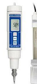
Figura 73 Electrodo para medición de pH según UNE-ISO 10390:2012 (2012)
