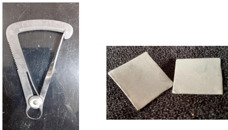
Fotografía Nro. 2. Aleación de cromo cobalto y cromo níquel coladas
