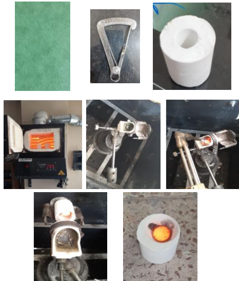
Fotografía Nro. 1. Proceso de colado
