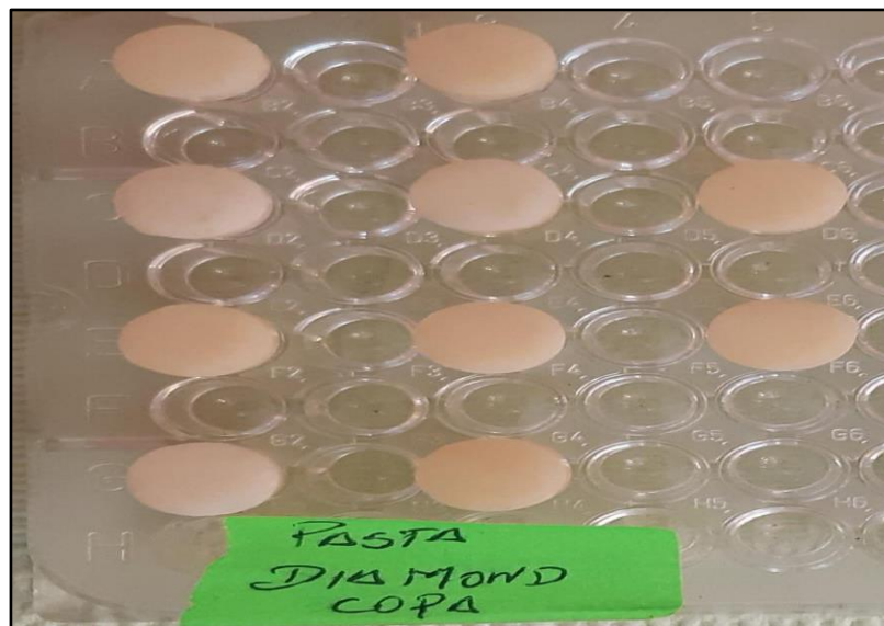
Figura Nro. 14. Muestras de resina para ser pulidas con copas de silicona más pasta Diamond Excel
