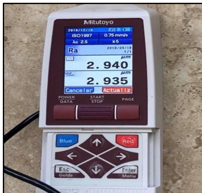
Figura Nro. 19. Rugosímetro calibrado para proceder con la medición de rugosidades superficiales de resinas
