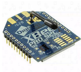
Figura 18 Módulo de comunicación ZigBee-Pro serie S2C. con antena
