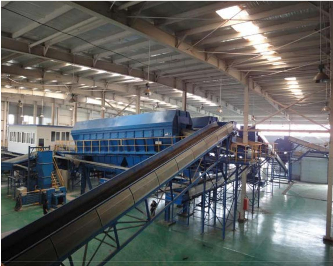
**Figura 22:** Módulo 1: Línea de Clasificación de Residuos Sólidos.
