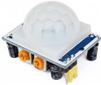
*Ilustración 103. Sensor de movimiento PIR*
