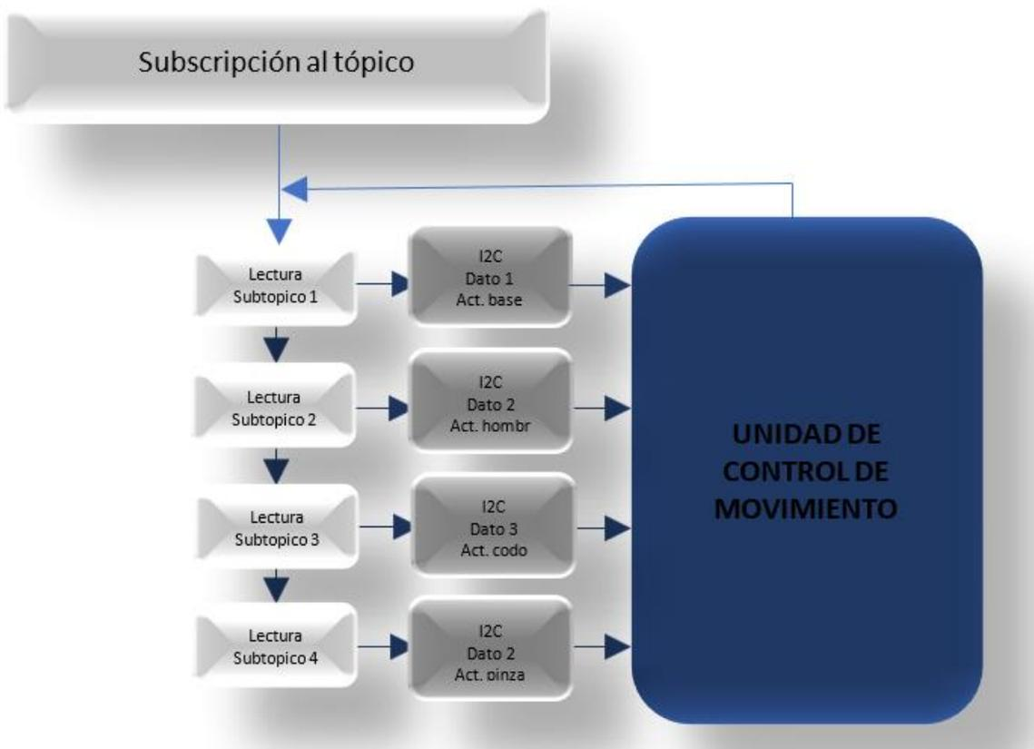
*Ilustración 19. Diagrama general del procesamiento de los datos obtenidos del bróker MQTT.*
