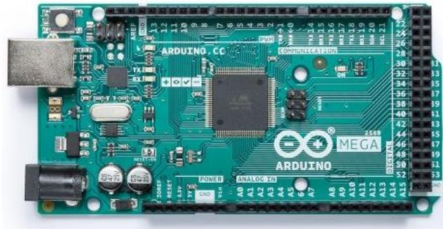
*Ilustración 93. Arduino MEGA 2560*
