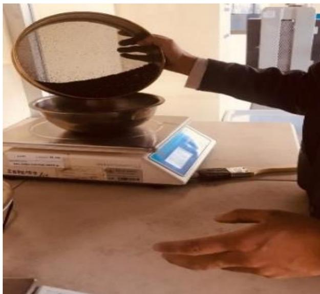
Foto\_9: colocación de árido fino en tamices
