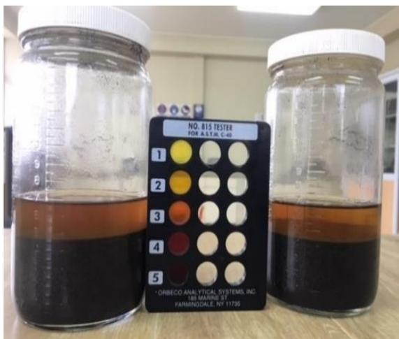
Figura 2. Determinación de impurezas orgánicas
