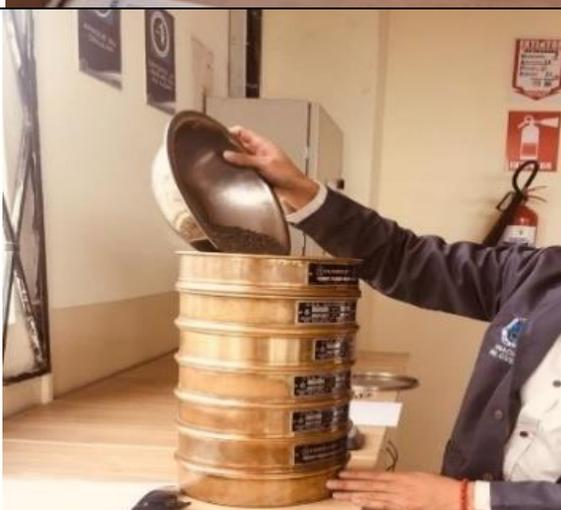
Foto\_10: Tamizadora mecánica para realización de ensayo de granulometría
