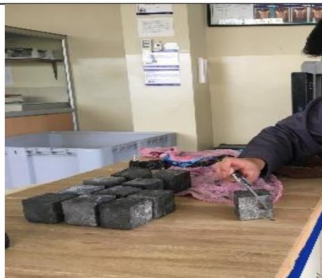
Foto\_23: Ensayo de cubo de mortero a compresión
