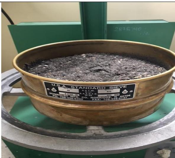
Foto\_4: Secado de la muestra una vez que ha sido tamizada.
