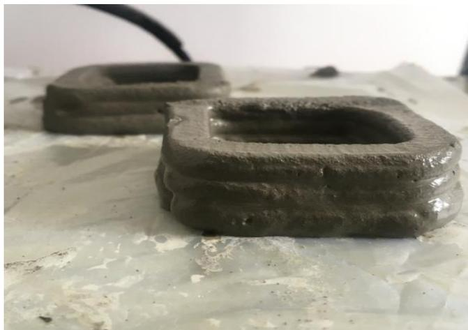
Figura 14. Impresión 3D con dosificación elegida
