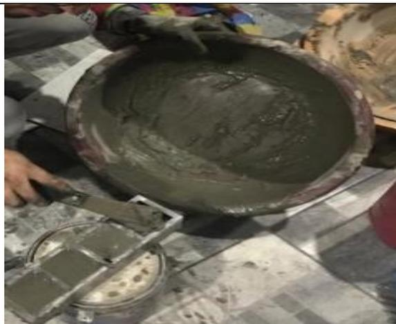
Foto\_19: Desencofrado de las probetas a las 24 horas
