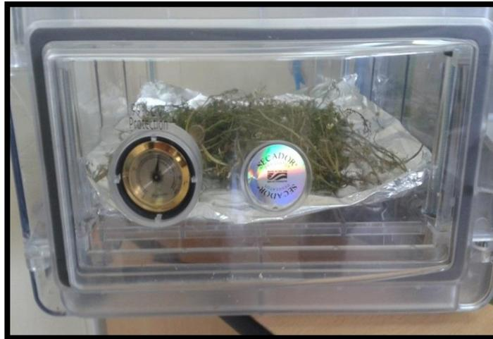
**Figura N° 19: Enfriamiento de manzanilla en el desecador**
