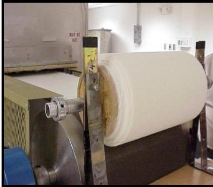
**Figura N° 4: Secador de rodillos**
