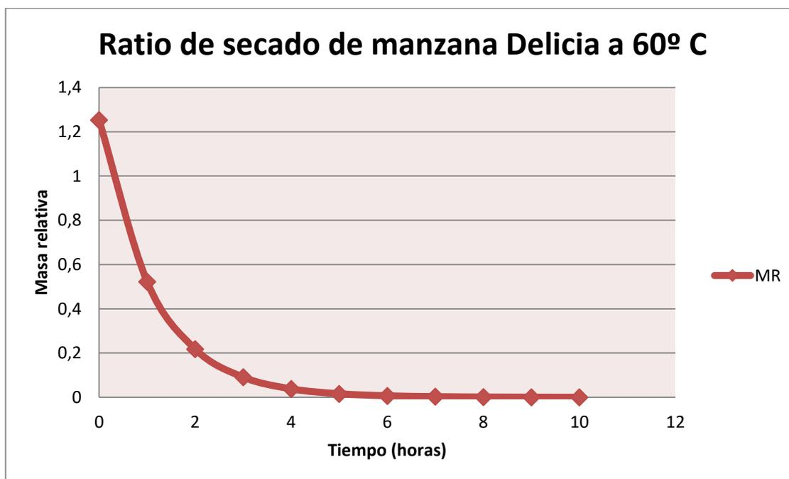
**Figura N° 45: Modelamiento del ratio de secado de la manzana Delicia a 60° C**
