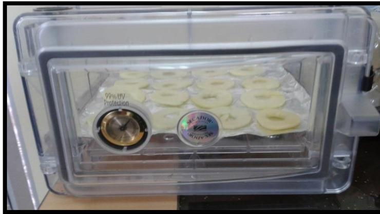
**Figura N° 14: Enfriamiento de manzana en el desecador**
