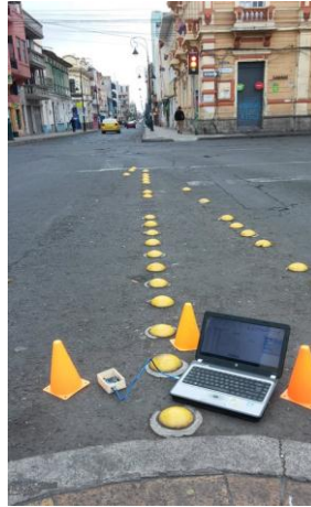
Figura 11 Instrumento para medición de temperatura (Fuente: Luis Cobo)
