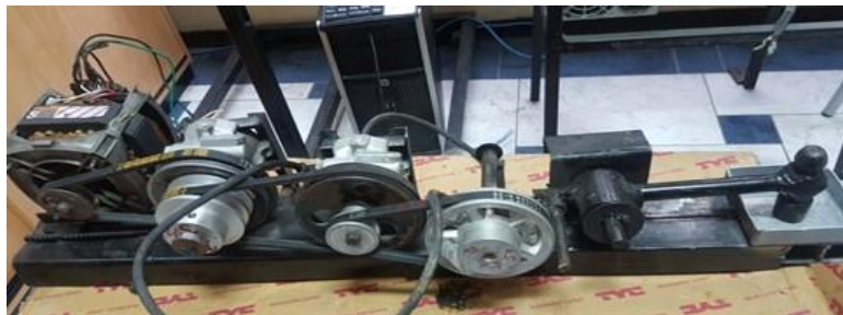
Figura 61. Construcción de la maquina molienda.
