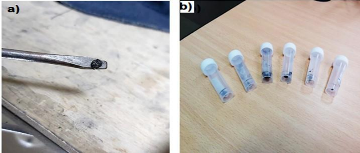
Figura 79. a) Muestra desprendida del cátodo. b) Diferentes tipos de muestras almacenadas en recipientes de plástico.
