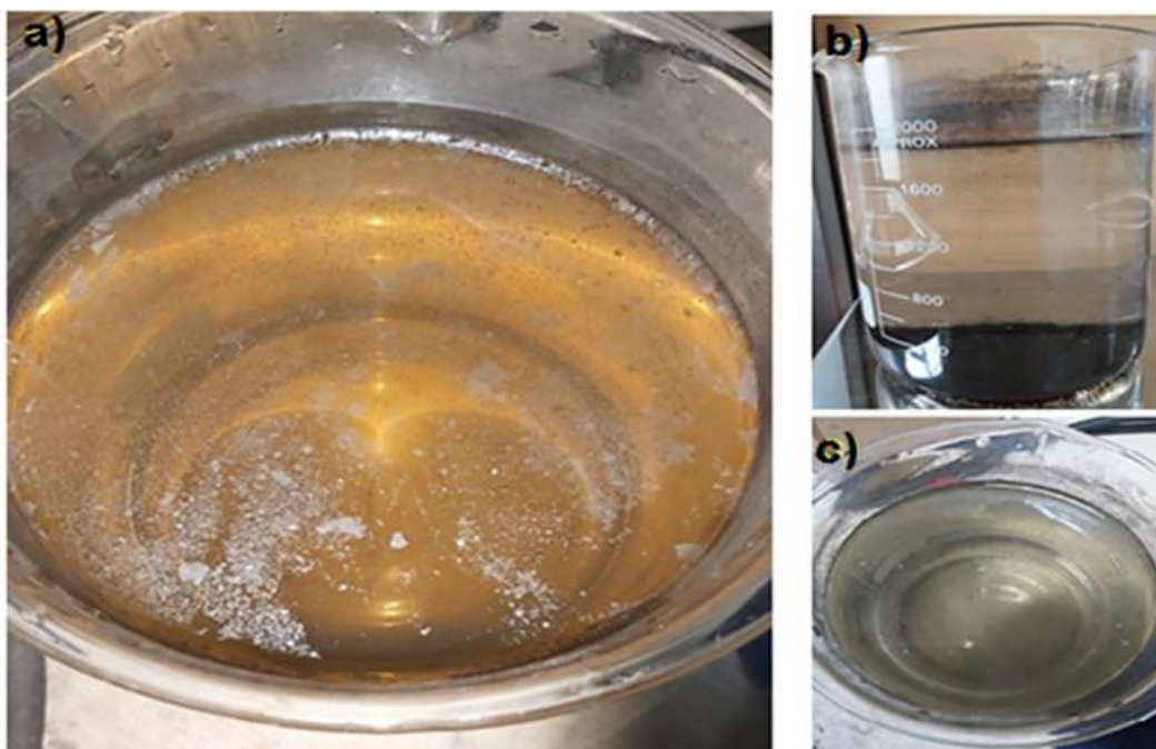
Figura 69. Aglomerados presentes en la superficie (a); retiros realizados en la parte inferior (b) y muestreo de superficie (c). Estas muestras no tienen ningún tratamiento para la caracterización de las mismas.
