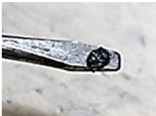
Figura 71. Pastilla formada en el cátodo siguiendo el proceso de síntesis.
