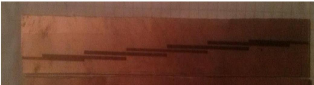
**Figura 4.3.** Impresión del formato del filtro Stripline en una cara de cobre.
