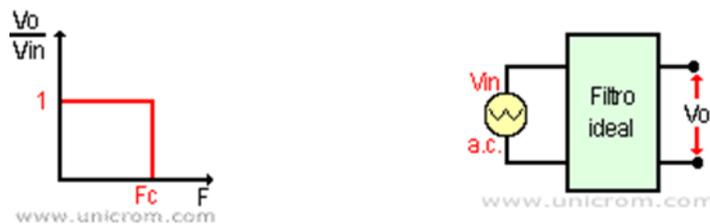
**Figura 1.2:** Representación de un filtro paso bajo ideal
