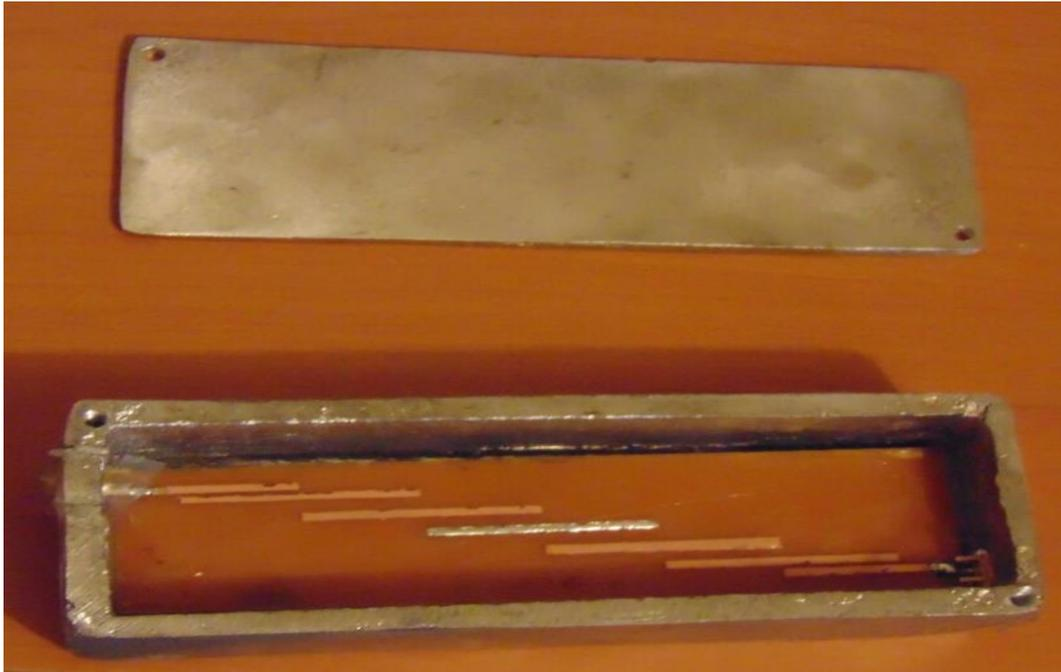
**Figura 4.9.** Tenemos el filtro MICROSTRIP colocado en su recinto de aluminio
