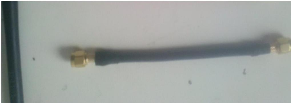
**Figura 4.8 Muestra del cable a utilizar para conectar el filtro a la tarjeta de red inalámbrica.**
