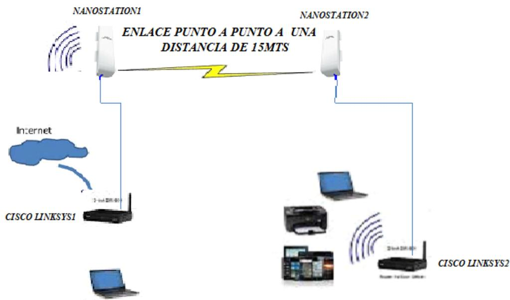
**Figura 5.3** Enlace punto a punto a una distancia de 15Mts
