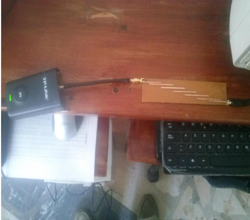
**Figura 5.1** Se muestra la conexión del filtro microstrip pasa banda con el demodulador del estándar Wifi.
