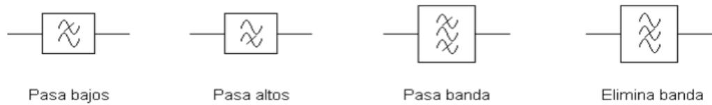
**Figura 1.9:** Detalle representación de filtros pasivos
