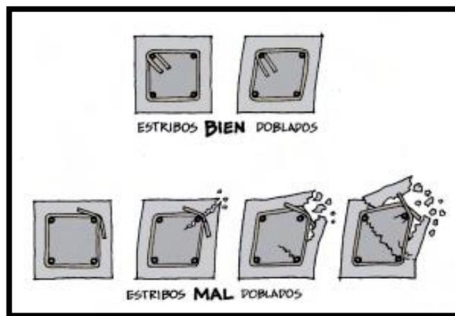
**Figura 94.** Detalle de Estribos en Columnas
