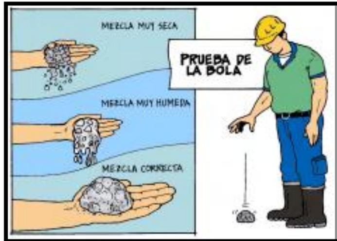
**Figura 65.**Prueba de la Bola en Hormigón
