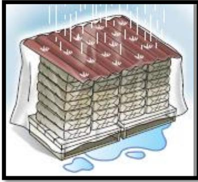
**Figura59.** Almacenamiento de Cemento
