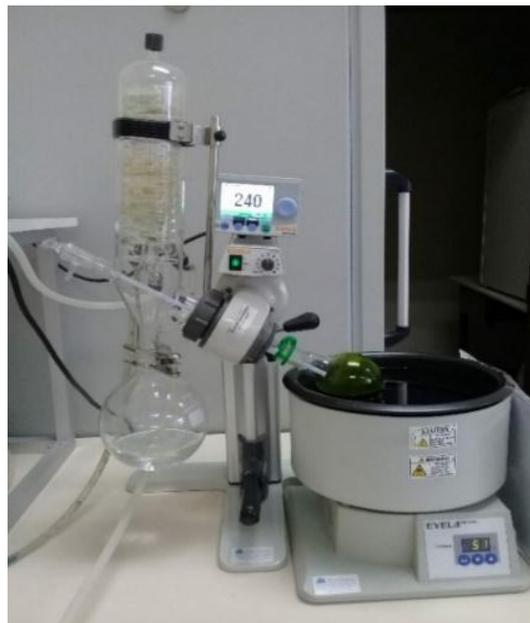
Por medio del equipo rotavapor se extrajo todas las partes metanólicas a una temperatura de 40°C y una presión de 260 hectopascales (hPa).
