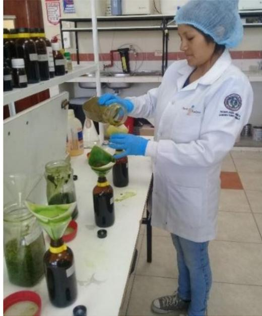
Se filtro cada una de las partes de la planta *Tanacetum* spp. con papel filtro para llevarlo a rotaevaporación.
