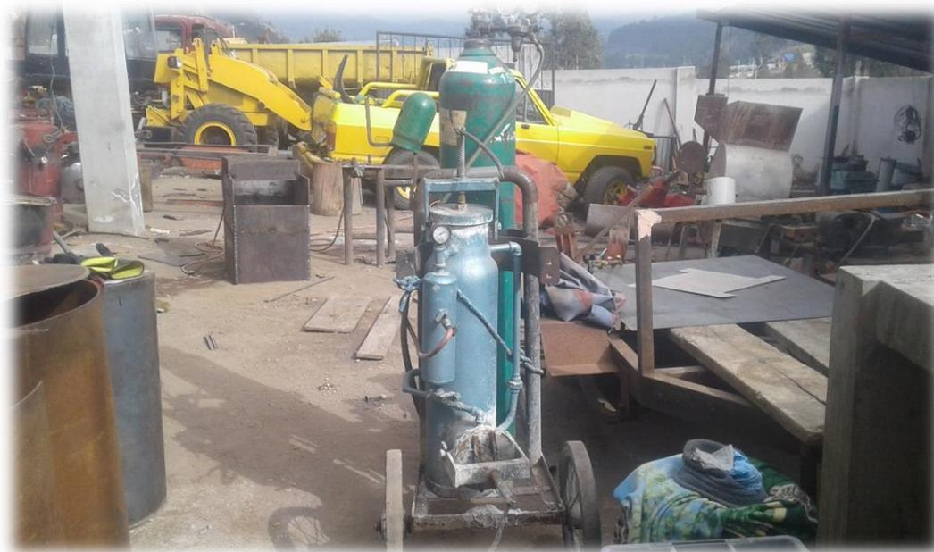
*Ilustración 48. Suelda Autógena*
