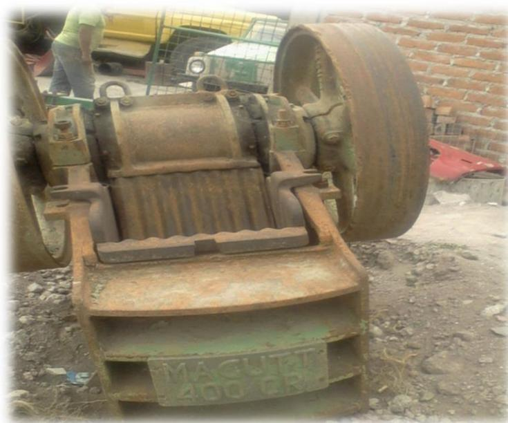
*Ilustración 55. Trituradora de Mandíbula Magutt 400R*
