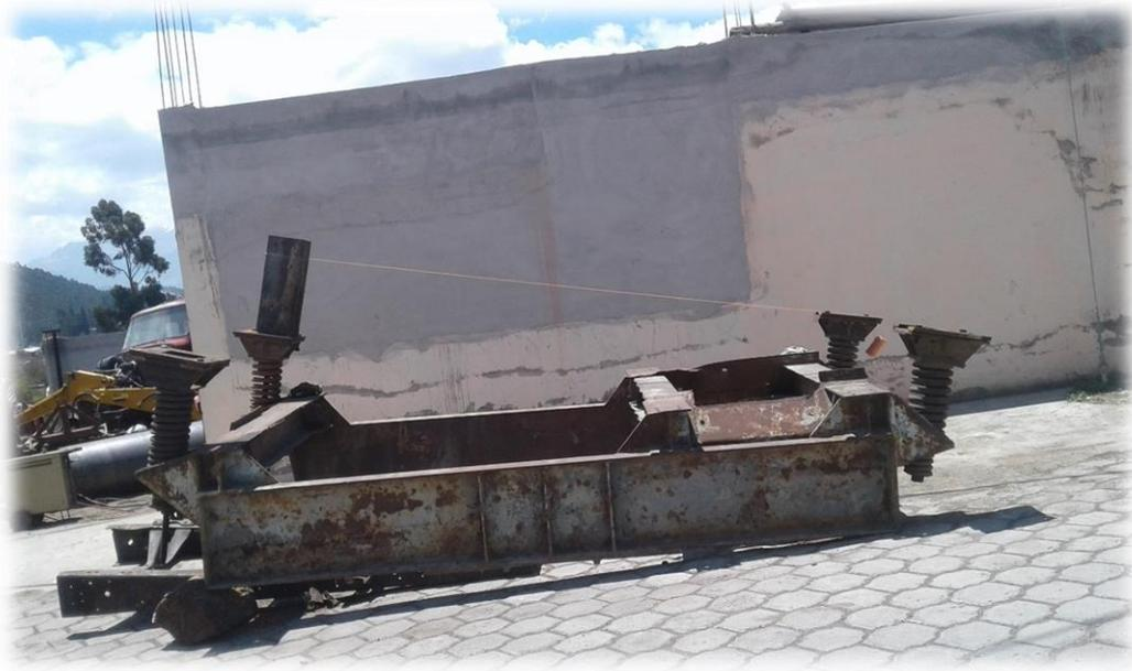
*Ilustración 58. Base de la Criba Vibratoria*
