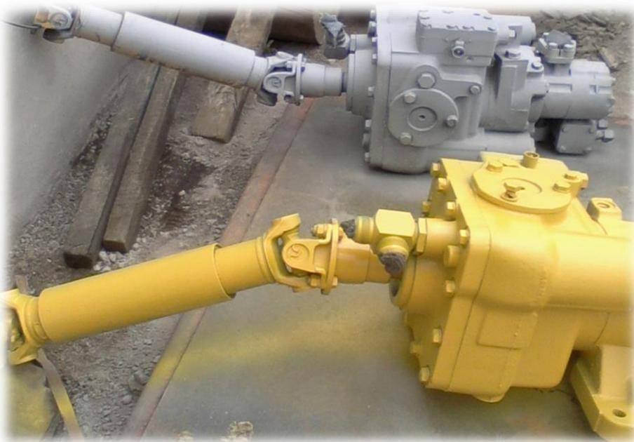
*Ilustración 63. Bombas Hidrostáticas*
