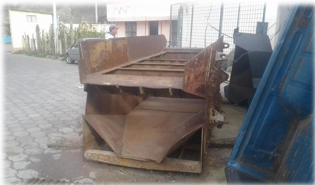
*Ilustración 57. Criba Vibratoria*
