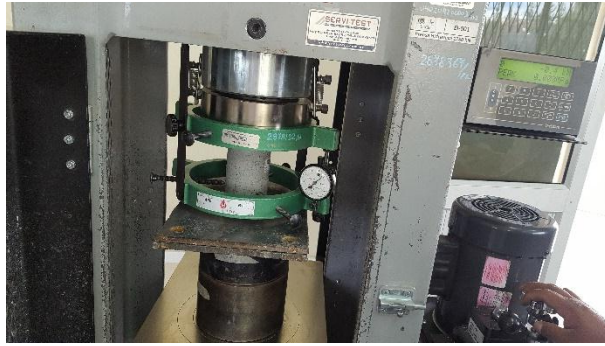
Figura 85. Ensayo de compresión en probeta de roca.
