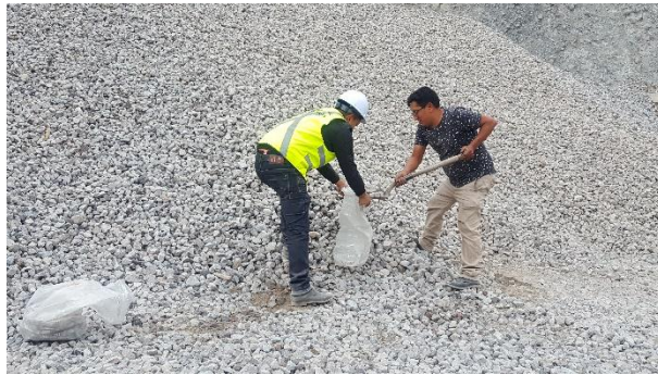
Figura 86. Obtención de muestras de agregado
