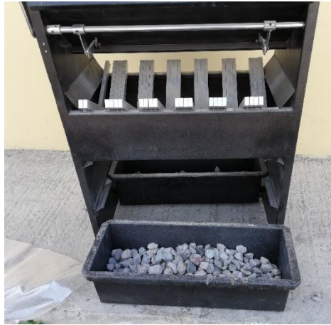
Figura 8. Separador mecánico para reducción de muestra
