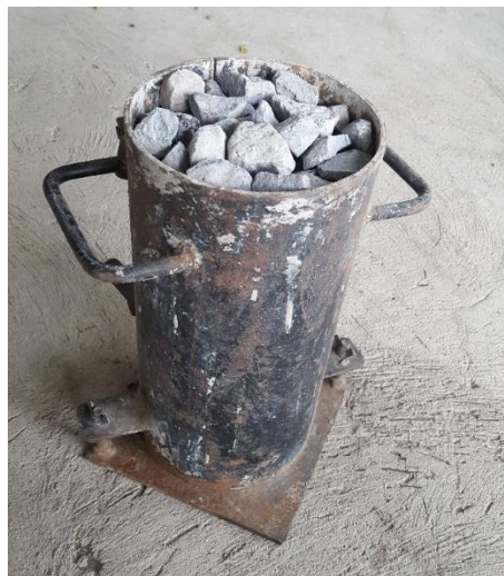
Figura 13. Agregado colocado en molde de cilindro
