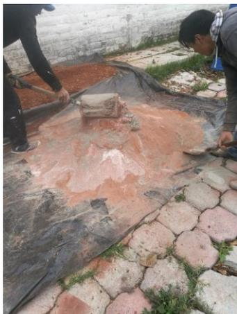
**Fotografía 23:** Pre mezcla en seco de la mezcla para M1.
