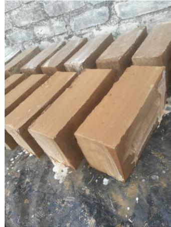
**Fotografía 20:** curado de los mampuestos M2 con aditivo.
