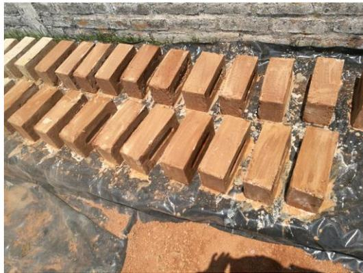
**Fotografía 27:** curado de los mampuestos M1 con aditivo.
