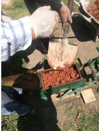
**Fotografía 25:** Colocación de la mezcla M1 en la prensa para adobes.
