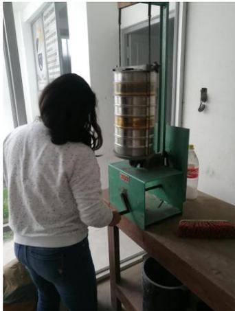
**Fotografía 9:** Segundo ensayo de granulometría.
