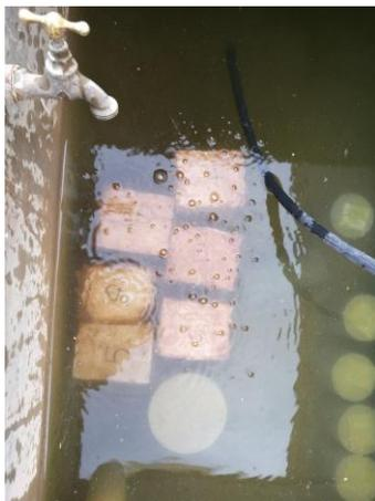
**Fotografía 41:** colocación de los mampuestos en las piscinas de curado para la absorción
