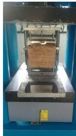
**Fotografía 42:** Ensayo a la flexión de M1 a los 28 días.
