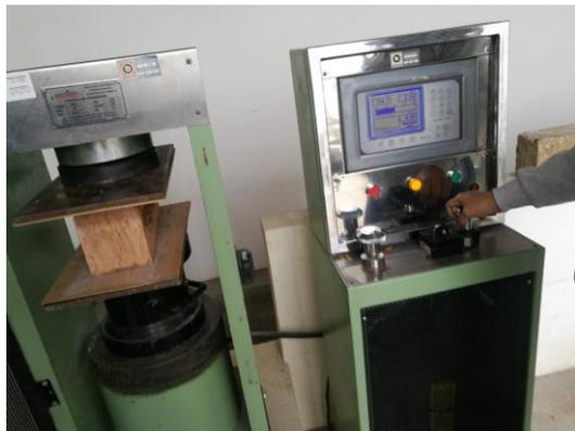
**Fotografía 29:** Ensayo a la compresión a los 7 días de M1.
