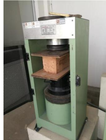
**Fotografía 32:** Ensayo a la compresión a los 14 días de M1.
