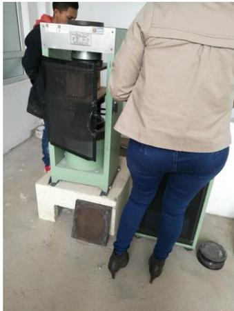
**Fotografía 39:** Ensayo a la compresión a los 28 días de M1.
