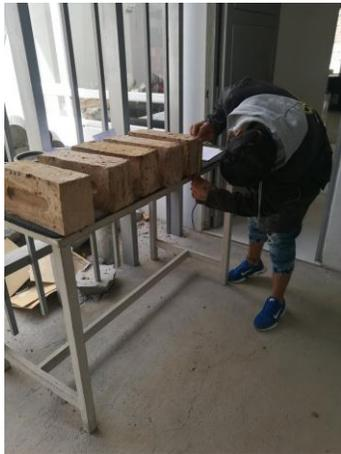
**Fotografía 33:** tomando la medida de los ladrillos antes del ensayo a compresión.
