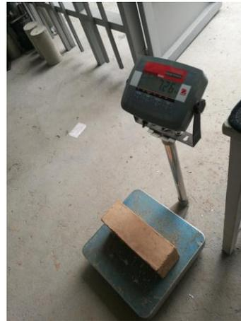
**Fotografía 28:** Peso de los mampuestos antes del ensayo a compresión.
