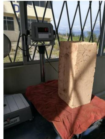
**Fotografía 40:** Peso de los ladrillos para la obtención de la absorción.
