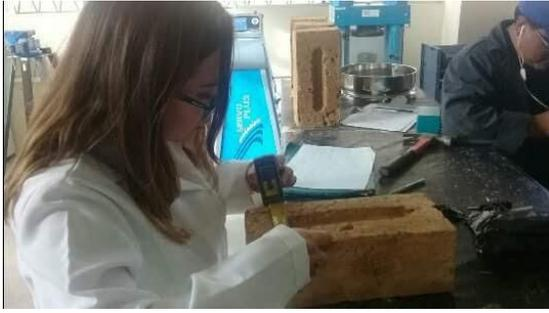
**Fotografía 37:** toma de las medidas de los ladrillos M2 previo a realizar el ensayo a flexión a los 28 días.
