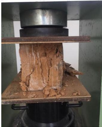
**Fotografía 31:** Ensayo a la compresión a los 14 días de M2.
