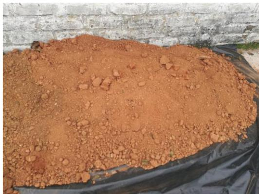
**Fotografía 13:** Secado de las arcillas al aire libre.
