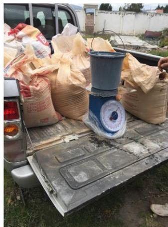
**Fotografía 16:** Peso de los materiales para la dosificación de M2.
