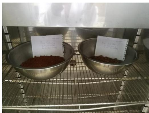
**Fotografía 6:** Secado de las muestras de arcilla en el horno.
