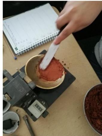
**Fotografía 10:** Ensayo del límite líquido de las arcillas.
