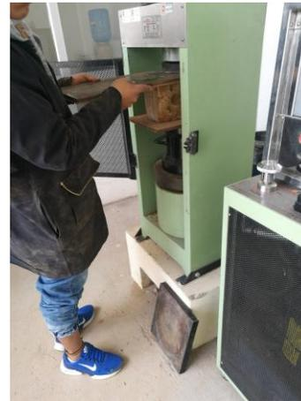
**Fotografía 34:** Ensayo a la compresión a los 21 días de M2.
