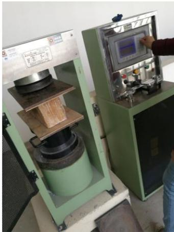
**Fotografía 21:** Ensayo a la compresión a los 7 días de M2.
