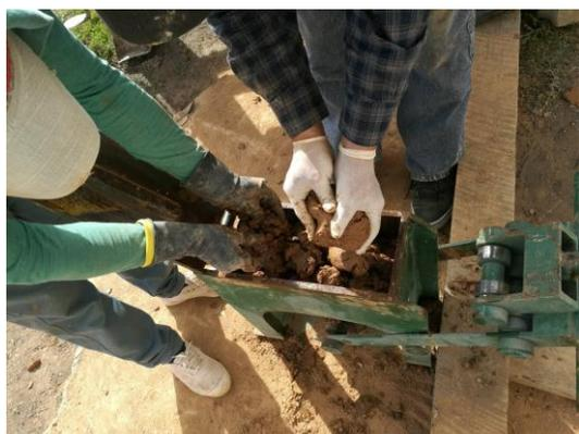
**Fotografía 17:** Colocación de la mezcla M2 en la prensa para adobes.
