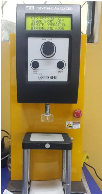
**Ilustración 10** Puesta a punto del equipo texturómetro previo a realizar el experimento
