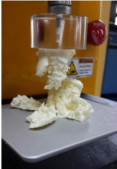
**Ilustración 12** Muestra de queso fresco en forma cilíndrica de 3 cm luego de aplicar la prueba de TPA a 1 mm/s y 75% de compresión
