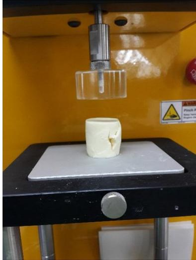
**Ilustración 11** Muestra de queso fresco en forma cilíndrica de 3 cm luego de aplicar la prueba de TPA a 0.3 mm/s y 75% de compresión
