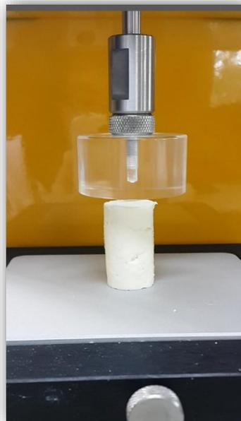
**Ilustración 6** Pieza TA4/1000 con muestra cilíndrica de 2 cm de diámetro x 3cm de altura.
